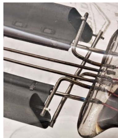
Fig.9. Conexión de los pines del AZ11, característica tensión-corriente (V-I) y dimensiones del AZ11. Detalle de la conexión de terminales
