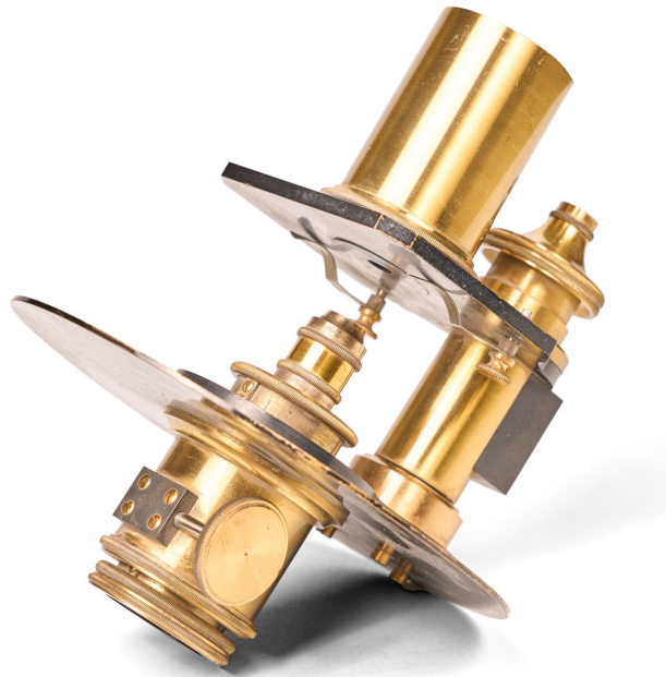
Figura 2. Detalle del microscopio proyector para preparaciones microscópicas fabricado por Max Kohl. Se identifican la platina, sobre la que se coloca la muestra, su sistema de diafragma (disco intercambiable con orificio que regula la apertura y el contraste de la iluminación), y el tubo óptico vertical destinado a guiar el haz que forma la imagen real aumentada hacia el sistema de proyección. No conserva el objetivo original
