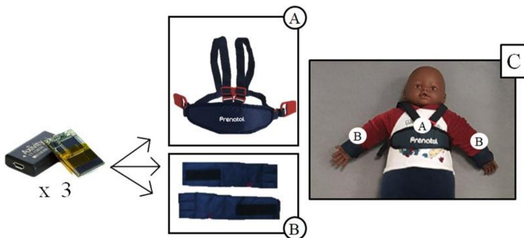
Figura 24. Ejemplo representativo de la colocación de un acelerómetro (155).
