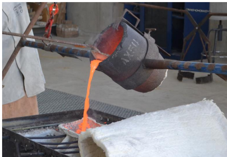
Figura 17. Imagen del momento del vertido del bronce en estado líquido en el interior del molde refractario.
