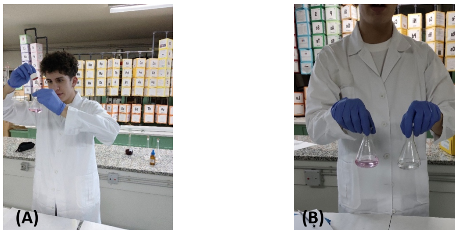
Figura 5. (A) Adición de disolución indicadora de fenolftaleína a una de las muestras de aguas en la determinación de carbonatos. (B) Observación del cambio de color de rosa a incoloro en las muestras de agua con cantidad detectable de carbonatos.
