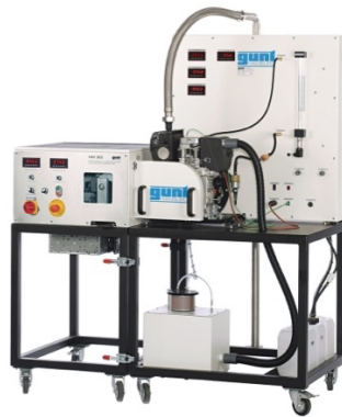
Figura 1. Banco de ensayos de un motor de combustión alternativo de 4 tiempos.
