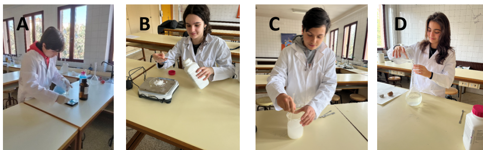
Figura 2. (A) Preparación de Fehling A. (B) Pesado de hidróxido de sodio. (C) Disolución de sal de Seignette y sosa. (D) Enrase de 1 L de Fehling B.
