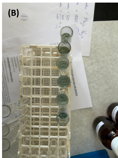
Figura 3. (A) Disoluciones madre de \text{KH}_2\text{PO}_4 para la preparación de patrones. (B) Disoluciones patrón de fosfato sometidas al mismo proceso químico que la muestra. (C) Traslado de un volumen del patrón a la cubeta de vidrio antes de medir la absorbancia.
