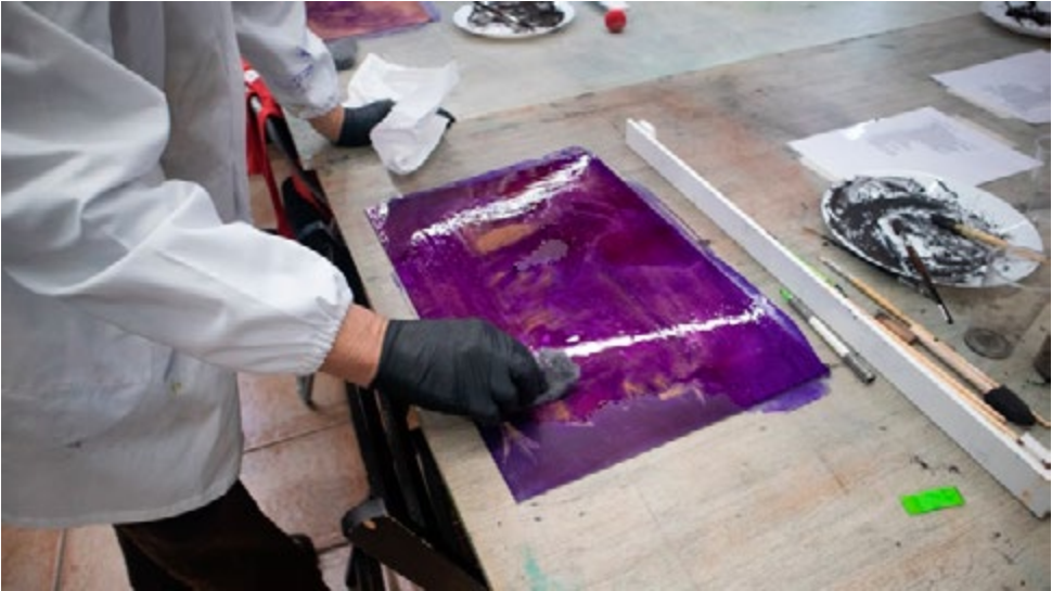
Limpiado de la plancha después del segundo mordido
