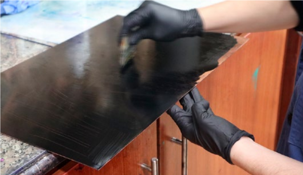
Entintado convencional con tinta negra aplicada con una rasqueta de plástico Entintado convencional con tinta negra aplicada cunha rasqueta de plástico
