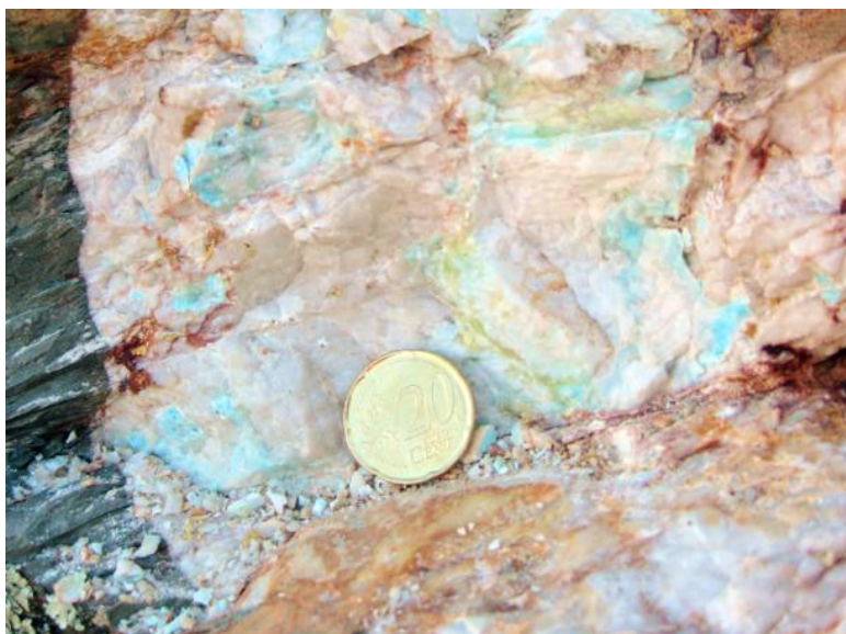
Figura 12. Filón de cuarzo con minerales de Li (amblygonita-montebrasita) y alteraciones a turquesa (Junta de Extremadura, 2019).
