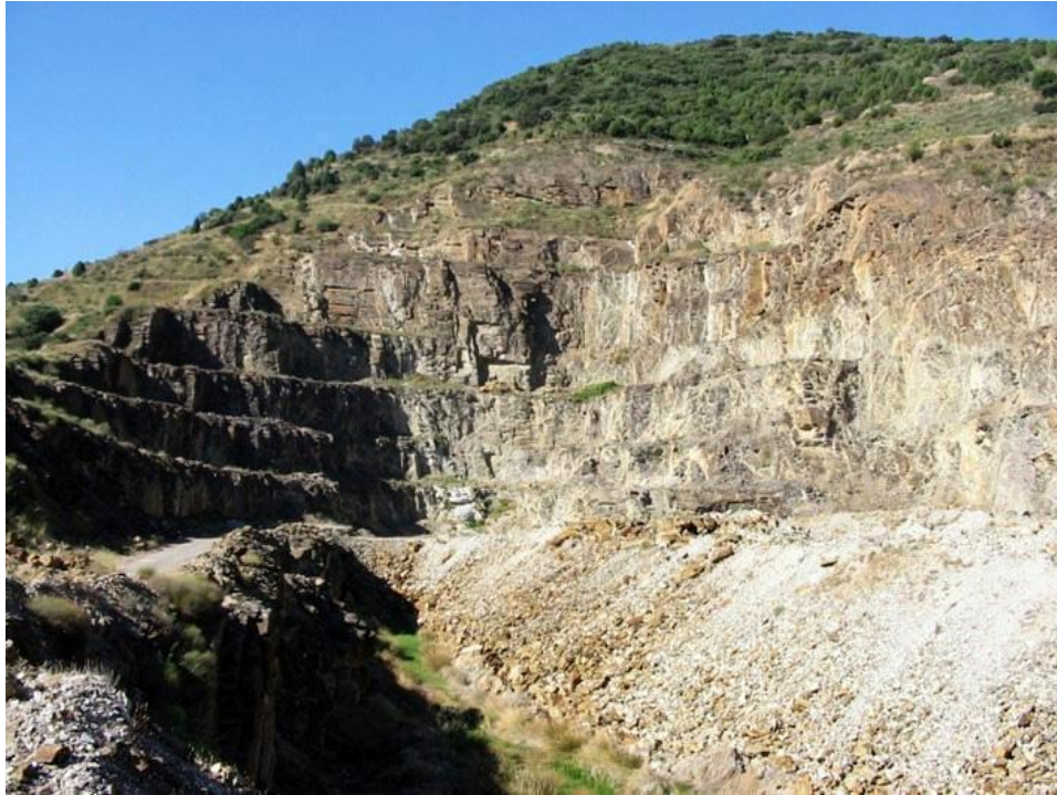
Figura 2. Mina Feli (La Fregeneda, Salamanca) donde se observa un stockwork de venas de cuarzo con casiterita y un vaciado (parte inferior de la fotografía) correspondiente a la pegmatita de Li con casiterita (Universidad de Salamanca, 2015).
