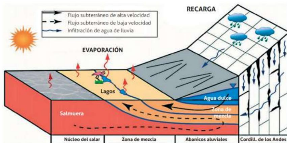
Figura 19. Modelo hidrogeológico y zonas de evaporación para la concentración de Li en salares (Marzuela et al., 2019).
