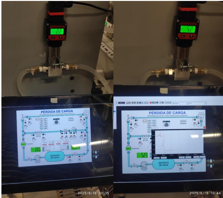
Figura 25. Transmisor de presión diferencial
