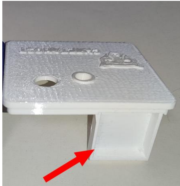
Ilustración 73 - Medidas erróneas y poco refuerzo.
