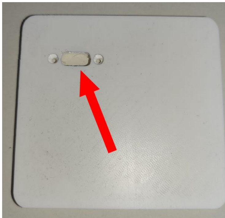
Ilustración 71 - Tapadera de carga con conector no correspondiente.
