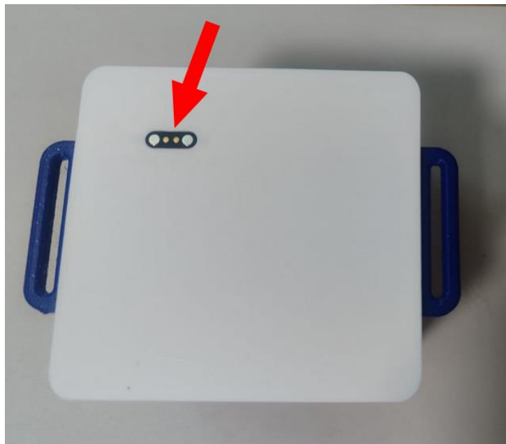
Ilustración 77 - Tapadera de carga con conector no correspondiente.
