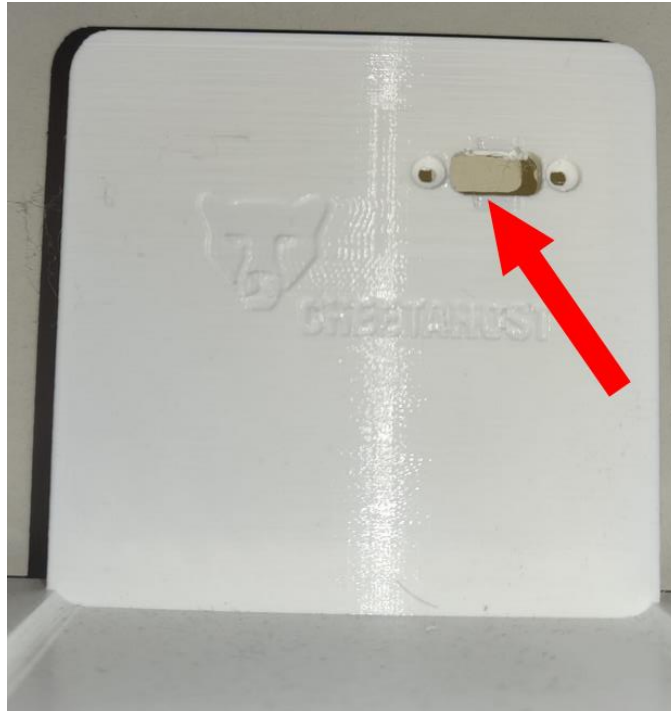
Ilustración 70 - Base de carga con conector no correspondiente.
