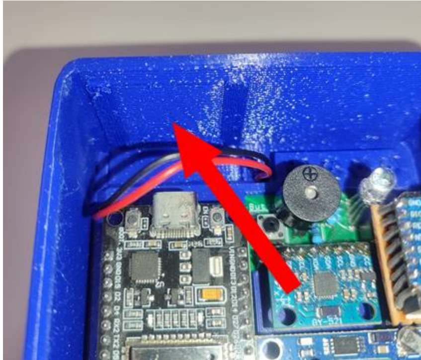
Ilustración 80 - Reducción del soporte superior antenna GPS.
