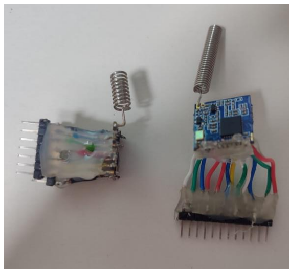
Ilustración 65 - Módulos LoRa ensamblados sin herramientas ni técnicas especializadas.
