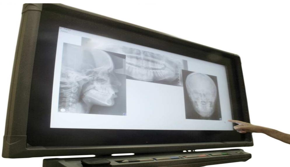
*Figura 9.- Pizarra digital interactiva multipunto, modelo SmartBoard, que disponemos en nuestras instalaciones de Abadia Group. No requiere conexión a cañón de proyección. Funciona directamente conectado al ordenador. Dispone de lapiceros de cuatro colores y borrador. Su manejo se puede desarrollar directamente con las manos, ofreciendo un gran dinamismo. En la imagen se visualiza unos de los proyectos desarrollados por nuestro grupo: negatoscopio digital interactivo (NID).*
