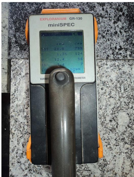
Fig.70. Surveying Gamma Ray Spectrometer (Escintilómetro).
