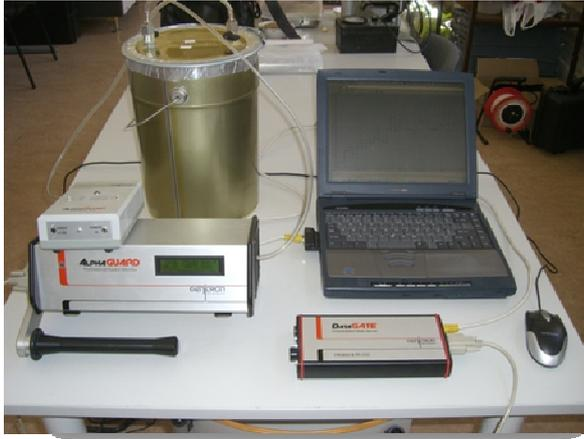
Fig.13. Instrumental preparado para realizar la medición de gas Rn en los contenedores.
