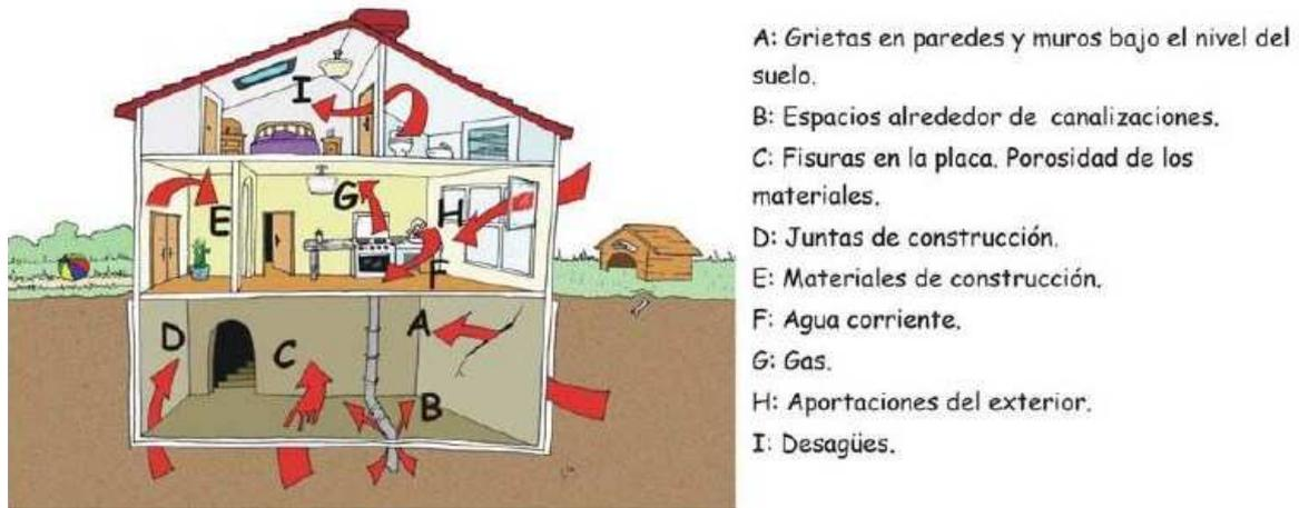
Fig.10. Posibles puntos de entrada de gas Rn en edificaciones. (Llerena.2006)
