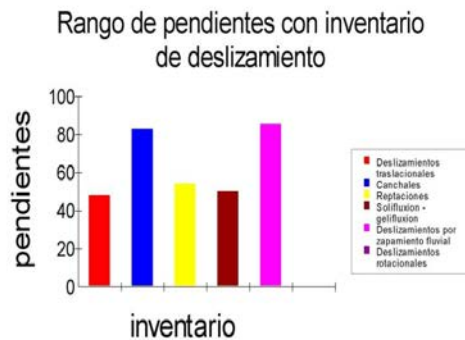
Figura III 4.1 -22. Análisis de la distribución de los diferentes grados de pendientes y los valores que presentan los diferentes movimientos de ladera inventariados en el sector de estudio.
