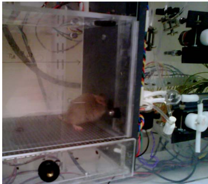
Figura 16. Ratón durante el proceso de aprendizaje. Nótese cómo introduce la cabeza a través de la apertura de la cámara de presentación del olor.
