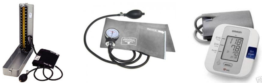
Figura 4. Tipos de esfigmomanómetros: de izquierda a derecha, esfigmomanómetro mercurial, aneroides y digital.
