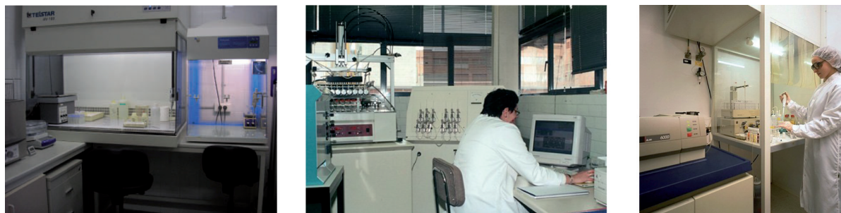
Figura 2.13. Fotografía del laboratorio en el que se realizaron la limpieza para análisis de elementos traza, en la Facultad de Geología de la Universidad de Barcelona (izquierda), espectrómetro de masas Finnigan MAT 252 (centro) utilizado en el análisis de isótopos estables, y el espectrómetro con ICP en el se analizaron los elementos traza (derecha). Imágenes de la página web de los servicios científico-técnicos de la Universidad de Barcelona ( http://www.sct.ub.es ).
