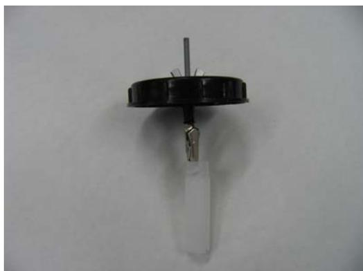
**Figura 12. Sistema para la recogida del  $^{14}\text{CO}_2$  en suelos incubados**
