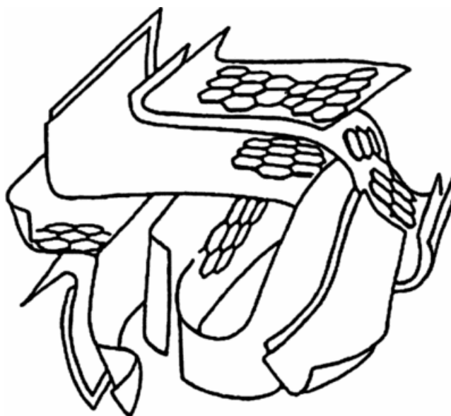
Figura 2.3. Estructura esquemática de un carbón activo (Bandosz, 2002).
