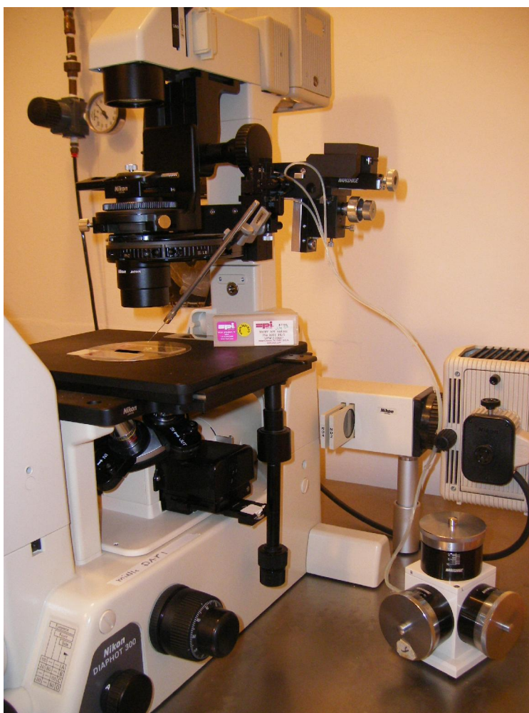
Figura 6.1. Estación de trabajo para el picking de cocolitos. Microscopio invertido (Nikon Diaphot 300), micromanipulador Narishige y aguja de tungsteno acoplada al micromanipulador.
