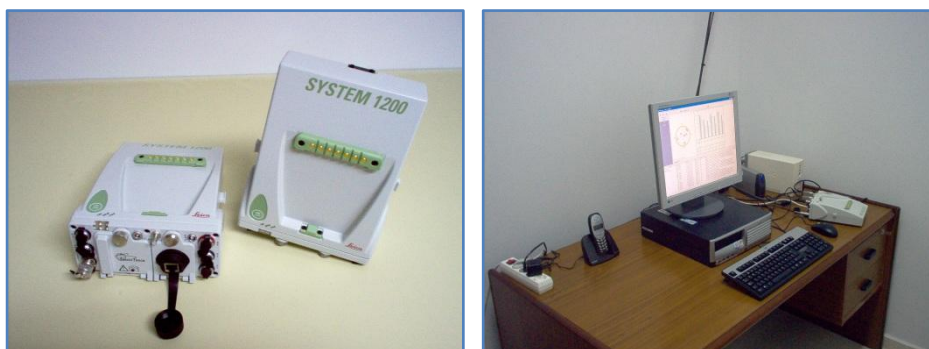
Figura 6.- Estación de Referencia y ordenador para su control (Universidad de Salamanca)
