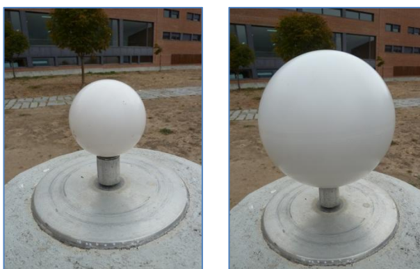
Figura 23.- Esferas de medición Trimble y Faro.
