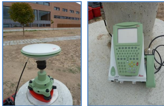
Figura 4.- Receptor GPS Leica System 1200 (Universidad de Salamanca)
