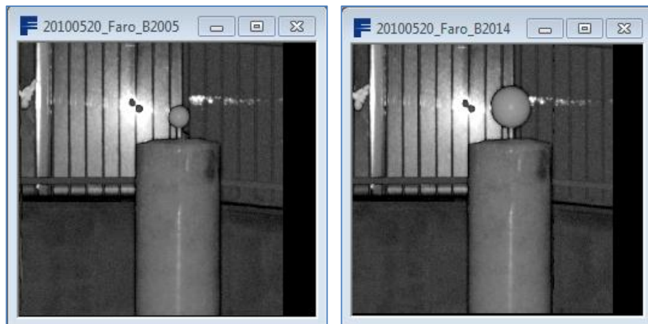
Figura 56.- Detalles de reflejos: diferentes esferas (Faro Scene 4.6)
