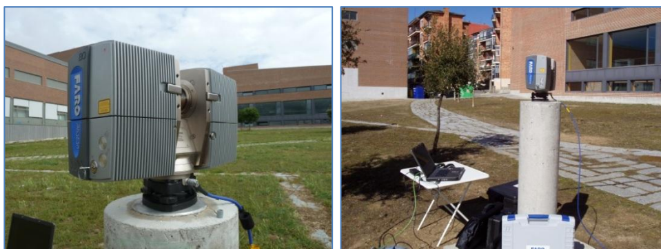
Figura 47.- Estacionamiento del escáner láser Faro Photon 80.
