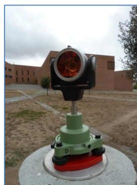
Figura 22.- Prisma Leica de alta precisión.
