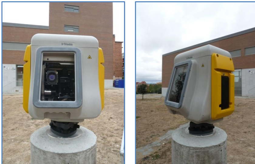
Figura 1.- Escáner Láser Trimble GX (Universidad de Salamanca)
