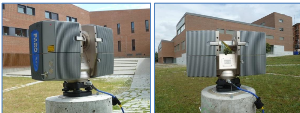
Figura 2.- Escáner Laser Faro Photon 80 (Universidad de Salamanca)
