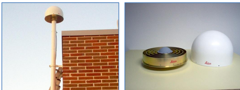
Figura 5.- Antena AT504 de la Estación de Referencia (Universidad de Salamanca)
