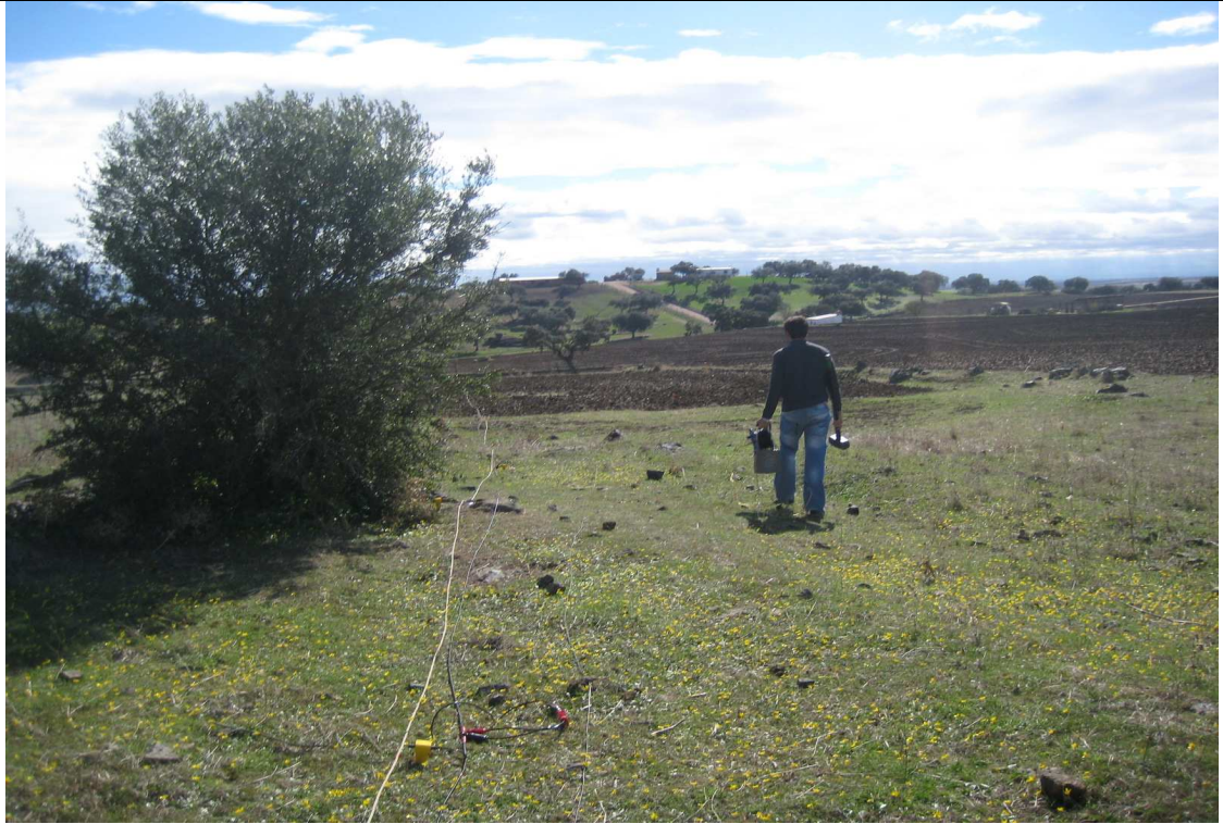
Fotografía 7. Vista general de desmonte P.K. 5+800 a P.K. 6+500 con dispositivo adoptado para realización de línea sísmica. Noviembre de 2.009.
