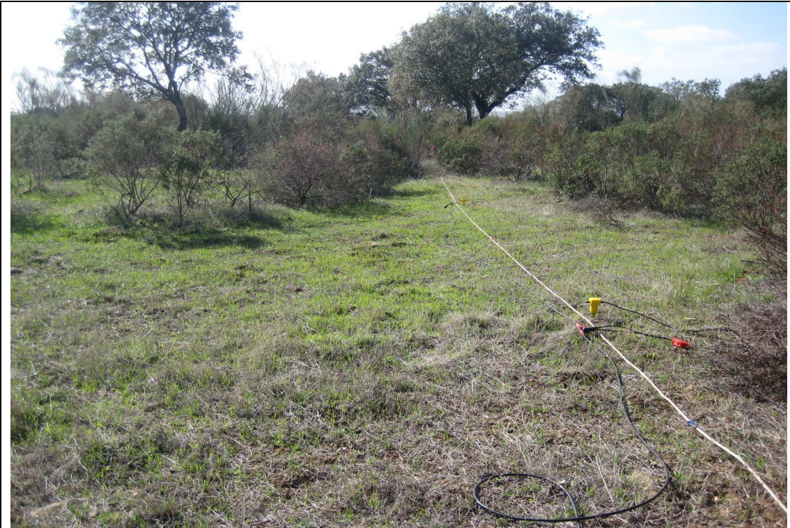
Fotografía 5. Vista general de desmonte P.K. 3+500 a P.K. 4+500 con dispositivo adoptado para realización de línea sísmica. Noviembre de 2.009.
