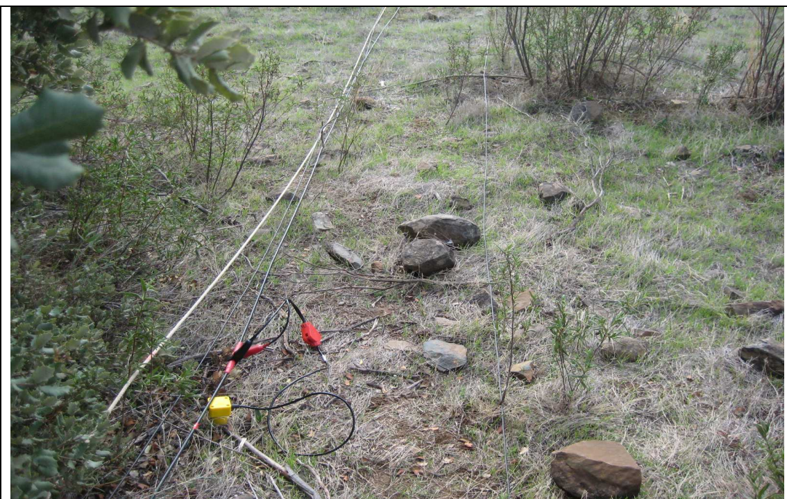
Fotografía 6. Vista general de desmonte P.K. 3+500 a P.K. 4+500 con dispositivo adoptado para realización de línea sísmica. Noviembre de 2.009.
