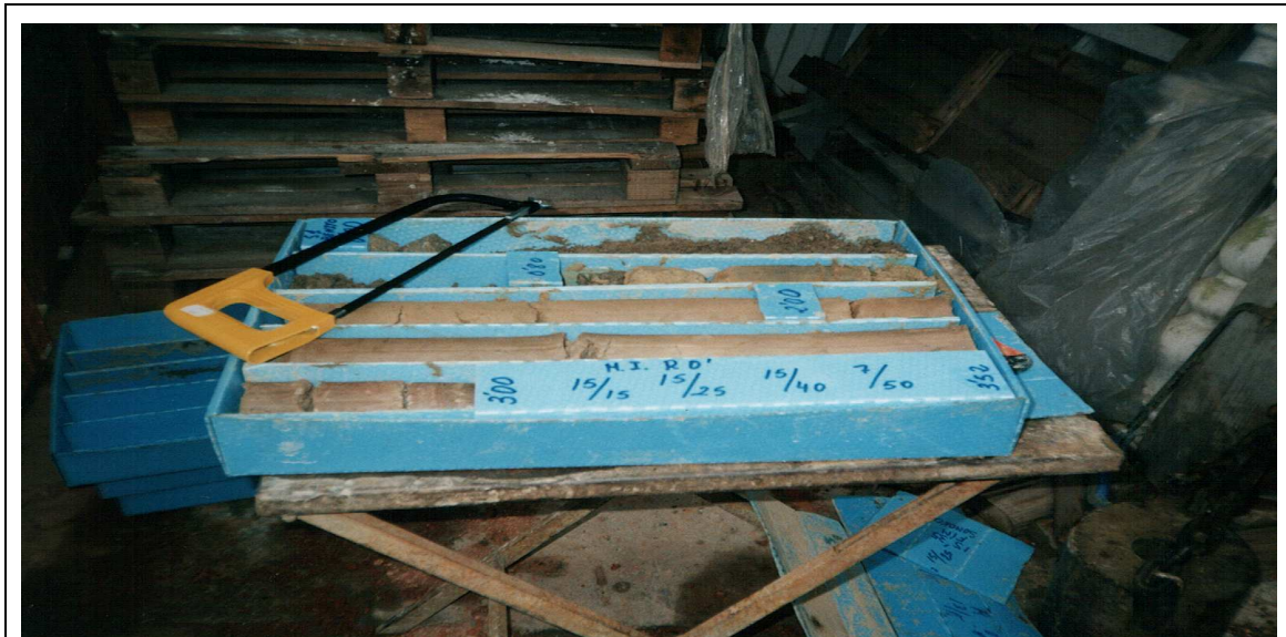
Imagen 7. Cajas Portatestigos con marcado de maniobras. Fuente: Elaboración Propia. Trabajos en campo en Don Benito (Badajoz). Año 2002.
