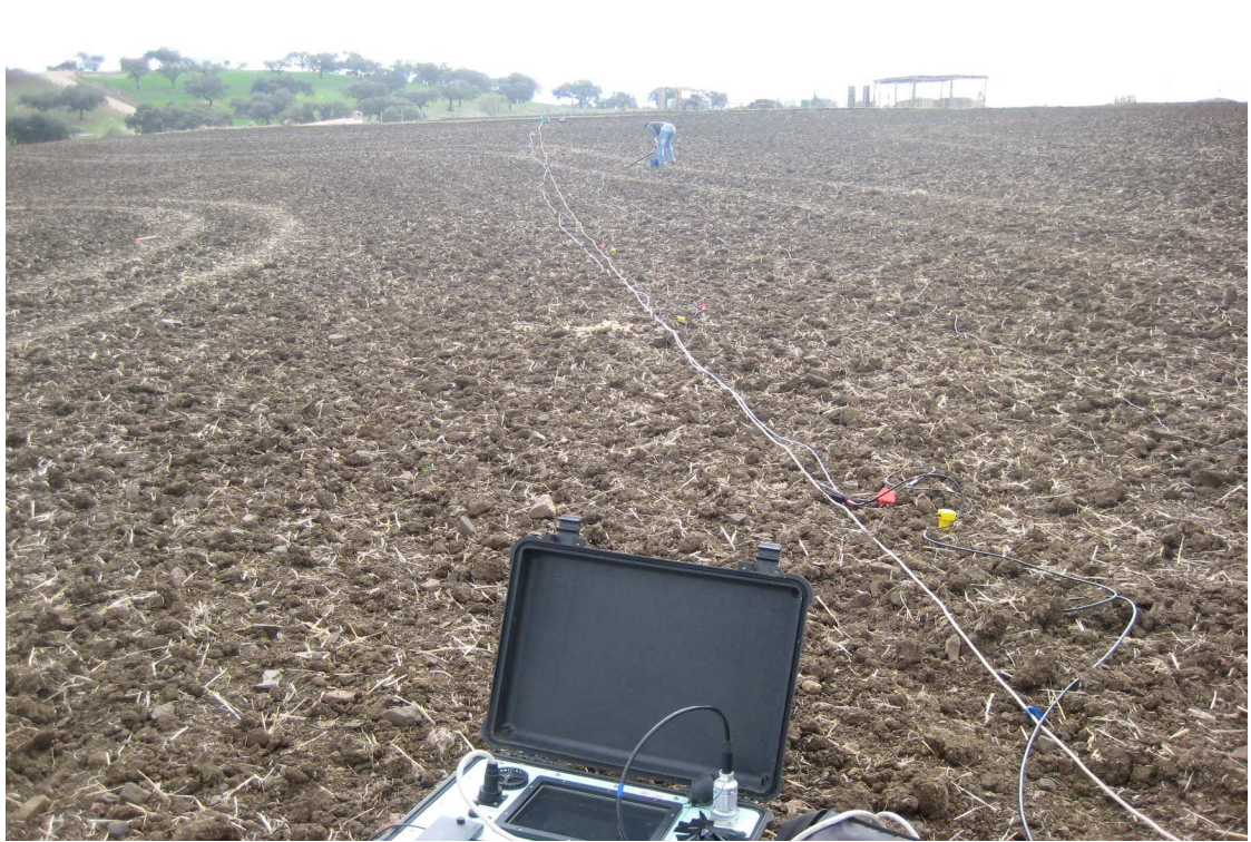
Fotografía 9. Vista general de desmonte P.K. 5+800 a P.K. 6+500 con dispositivo adoptado para realización de línea sísmica. Noviembre de 2.009.
