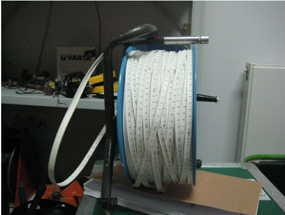
Imagen 12. Cinta de nivel graduada para mediciones de niveles freáticos en sondeos. Fuente: Elaboración Propia. Año 2010.
