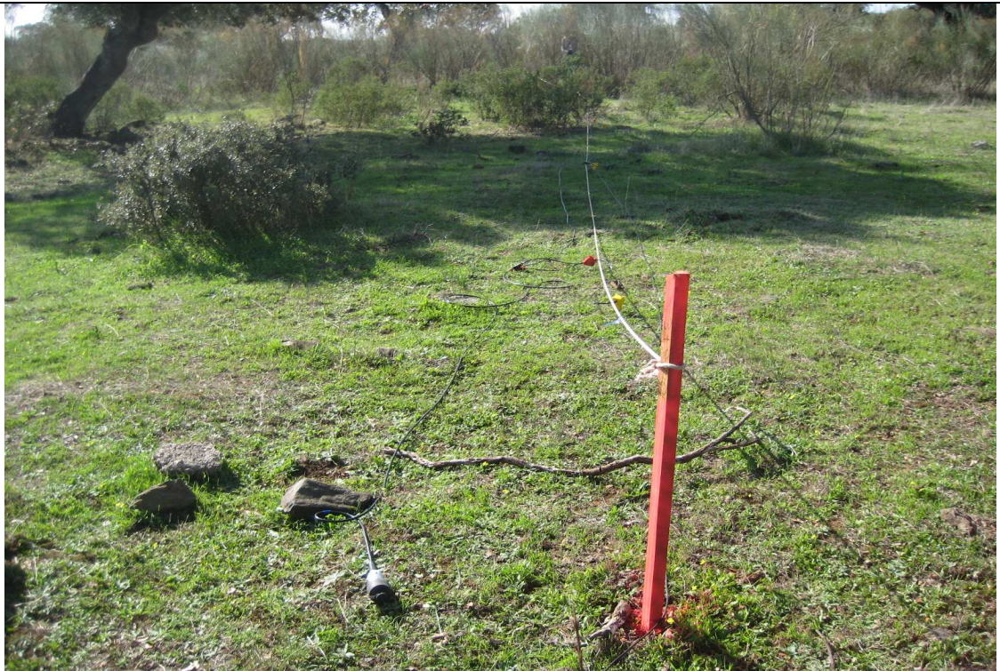
Fotografía 4. Vista general de desmonte P.K. 3+500 a P.K. 4+500 con dispositivo adoptado para realización de línea sísmica. Noviembre de 2.009.
