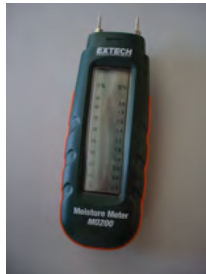
Figura 3: Dispositivos para medir la humedad en rocas y hormigones. El primero es exclusivo de hormigones y yesos.
