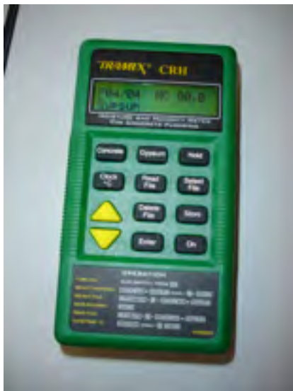
Figura 3: Dispositivos para medir la humedad en rocas y hormigones. El primero es exclusivo de hormigones y yesos.
