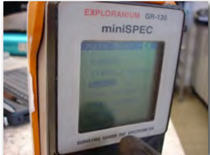
Figura 2: Escintilómetro portátil de rayos gamma exploranium GR-130G. Se usó para medir la concentración de elementos radiogénicos (uranio, torio y potasio) en muestras de preparadas.
