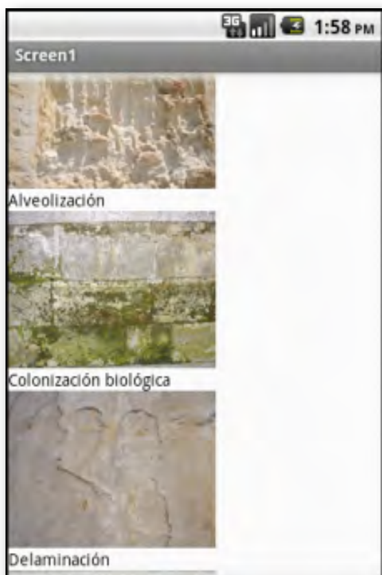
Figura 63: Apartado dedicado a las patologías de las rocas de la Catedral Nueva.
