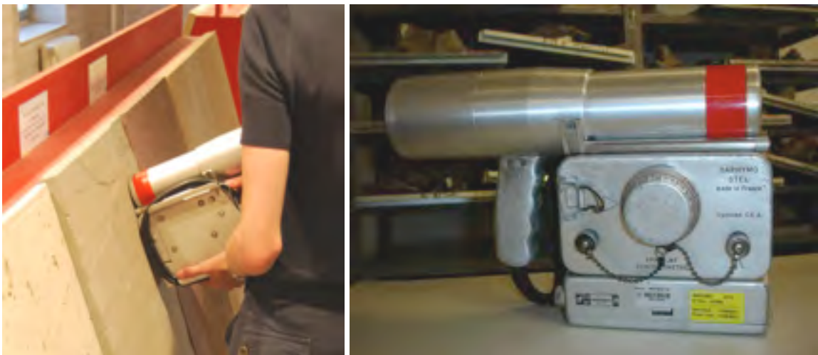
Figura 1: Realización de medidas de radiactividad natural en diferentes tipos de rocas mediante un espectrómetro de centelleo.
