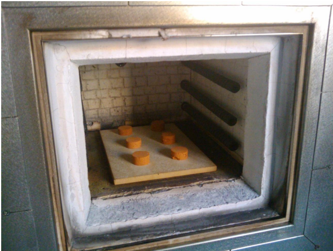
Figura. 24. Conjunto de muestras en verde en el momento que se introducen en el horno de mufla.
