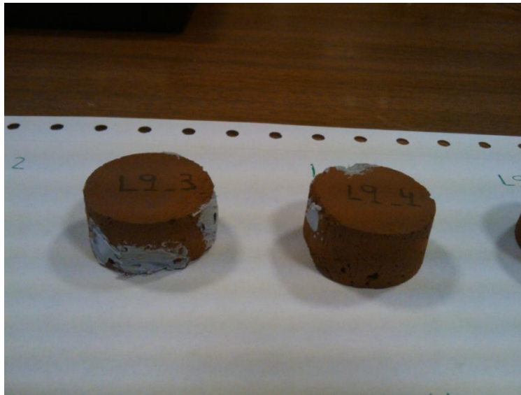
Figura. 33. Reparaciones efectuadas en las muestras para evitar grandes cavidades que originen datos erróneos en los ensayos.
