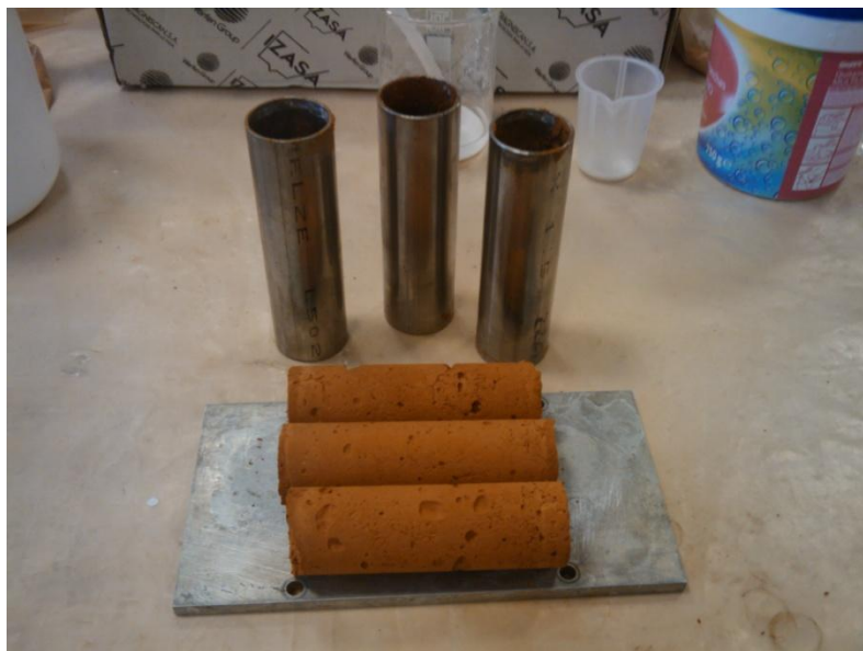
Figura. 23. Piezas extraídas de los moldes. Estado de las probetas en verde.
