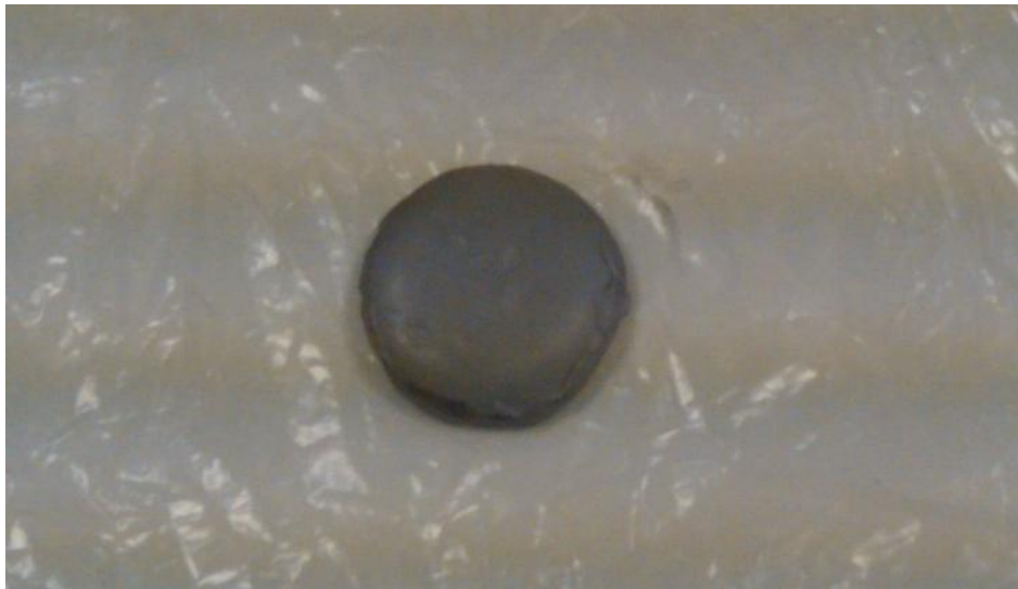
Figura. 34. Testigo de silicona empleado para contrastar los datos de las probetas reparadas.
