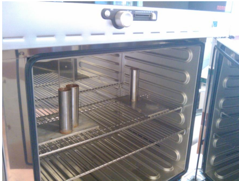
Figura. 22. Proceso de secado. Las piezas son retiradas de las bases para facilitar la pérdida de humedad.
