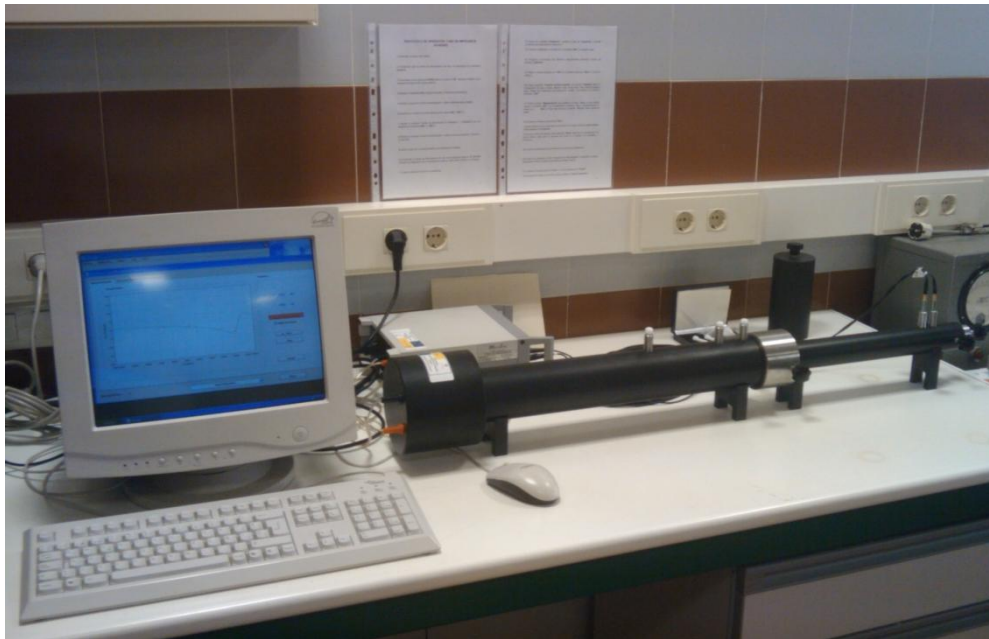
Figura. 31. Vista completa del equipo del tubo de impedancia acústica, en pantalla gráfica de la función de transferencia.
