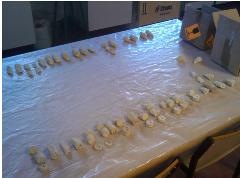
Figura. 21. Inventario de probetas ensayadas a compresión, empleado para obtener muestras para ensayos acústicos.
