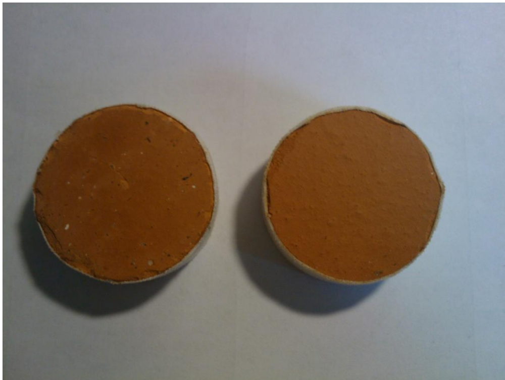
Figura. 36. Diferencias superficiales de la muestra LC16.3 (Izquierda), y LC3.1 (Derecha).
