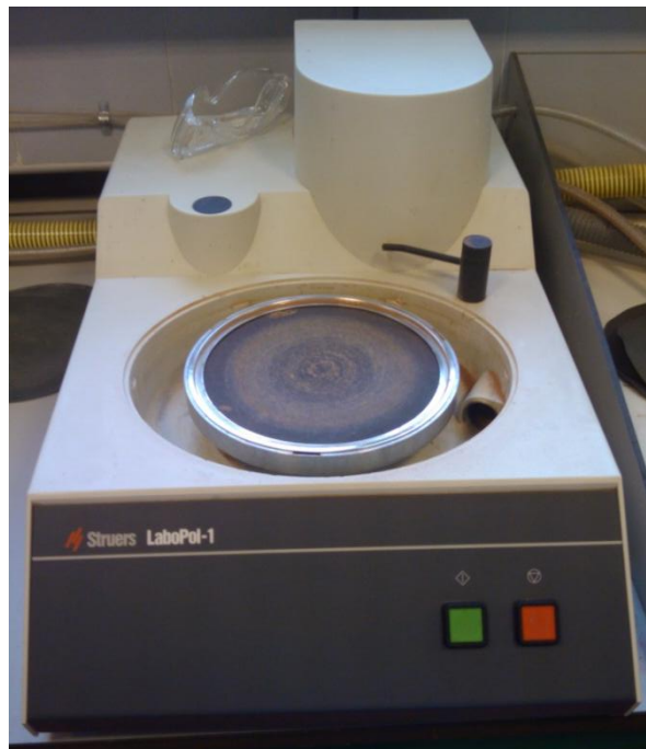
Figura. 18. Pulidora Struers LaboPol-1, empleada para obtener el grado superficial deseado en las muestras.
