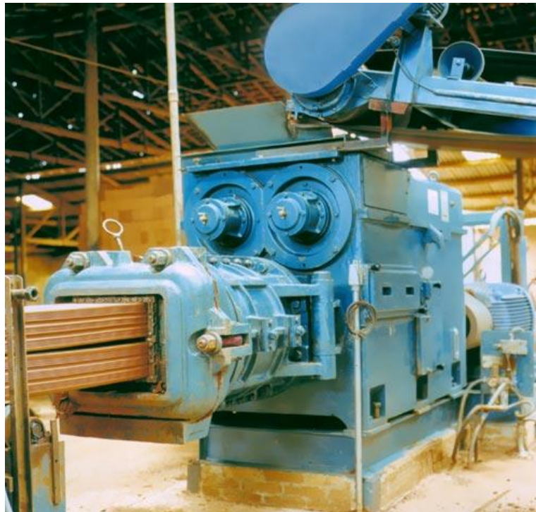
Figura. 8. Extrusora de vacío para ladrillos convencionales [77].
