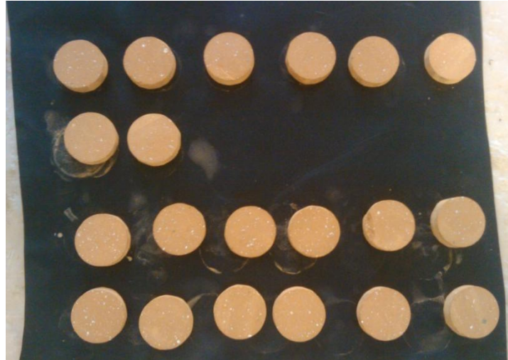
Figura. 19. Conjunto de muestras de ladrillo caravista (LC), en el momento en que se efectuaba el corte. Se observa la lámina empleada para evitar las vibraciones.
