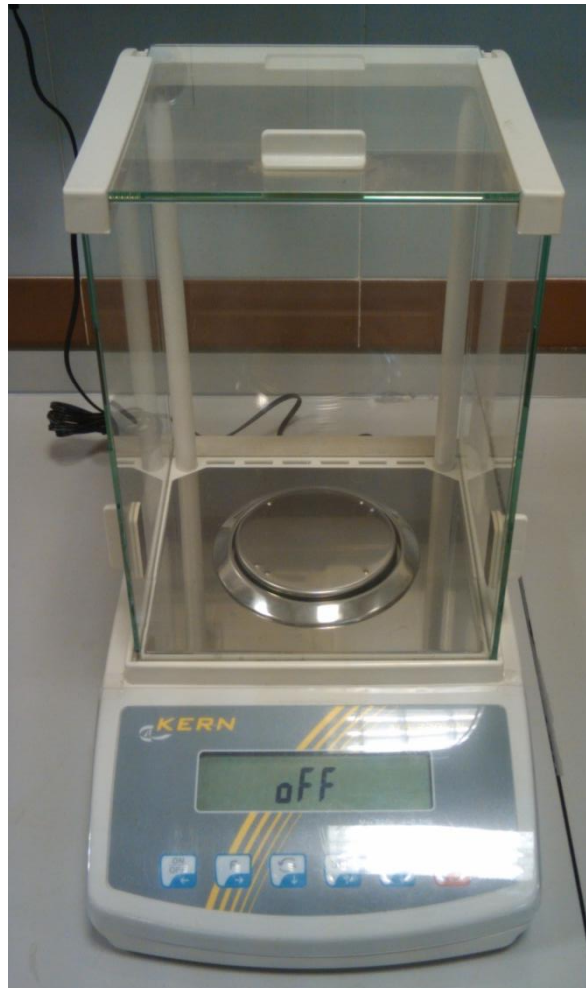
Figura. 30. Balanza de precisión empleada para determinar la masa de las probetas.
