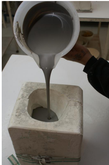
Figura. 7. Moldeo en barbotina, fase de vertido de la pasta [81].
