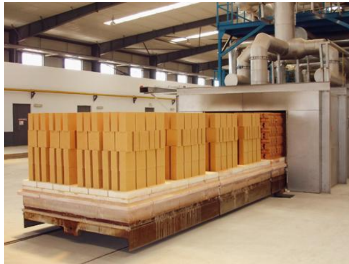
Figura. 17. Línea de producción de ladrillos, proceso de entrada en horno continuo [78].
