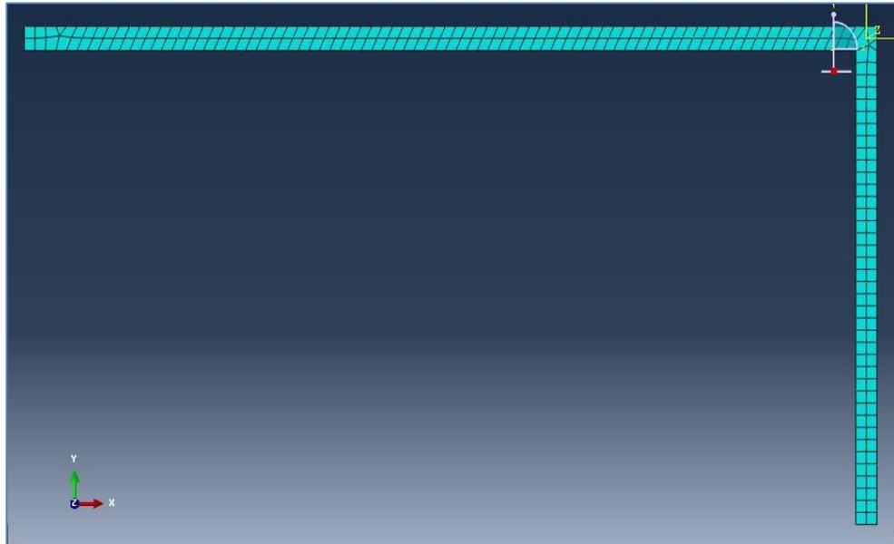
La solución para eliminar esa distorsión es utilizar las particiones para aislar el codo y ayudar al programa a mallar el modelo.
