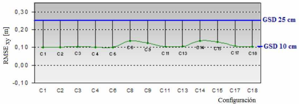
Fig. 5.28. Representación gráfica de los errores medios cuadráticos de las discrepancias planimétricas ( RMSE_{XY} ) de las aerotriangulaciones del vuelo combinado a dos alturas con GSD 10 cm + GSD 25 cm.
