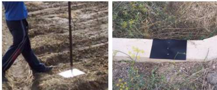
Fig. 4.5. Ejemplo de tarjetas de puntería usadas en vuelos fotogramétricos sin detalles fácilmente identificables sobre el terreno.
