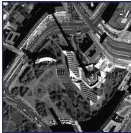
Fig. 3.13. Efecto en las imágenes ocasionado por las rotaciones de la cámara durante el vuelo (Titarov, 2007).
