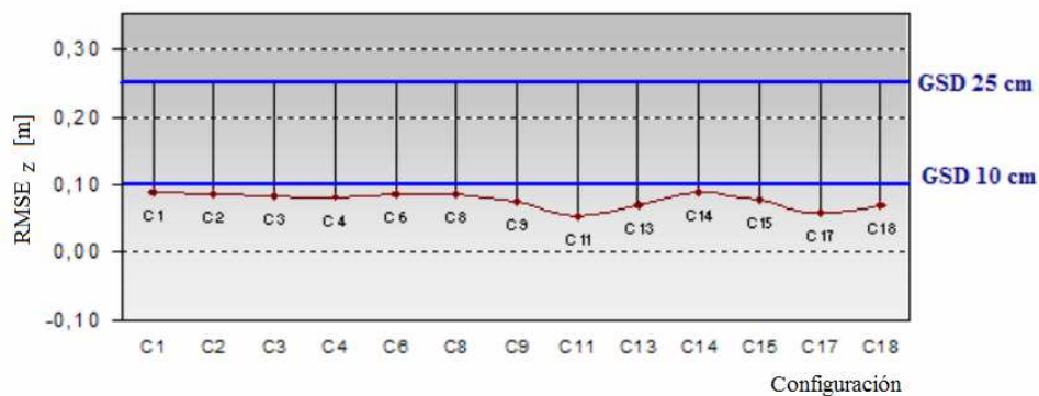
Fig. 5.31. Representación gráfica de los errores medios cuadráticos de las discrepancias altimétricas (RMSE Z ) de las aerotriangulaciones del vuelo combinado a dos alturas: GSD 10 cm + GSD 25 cm.
