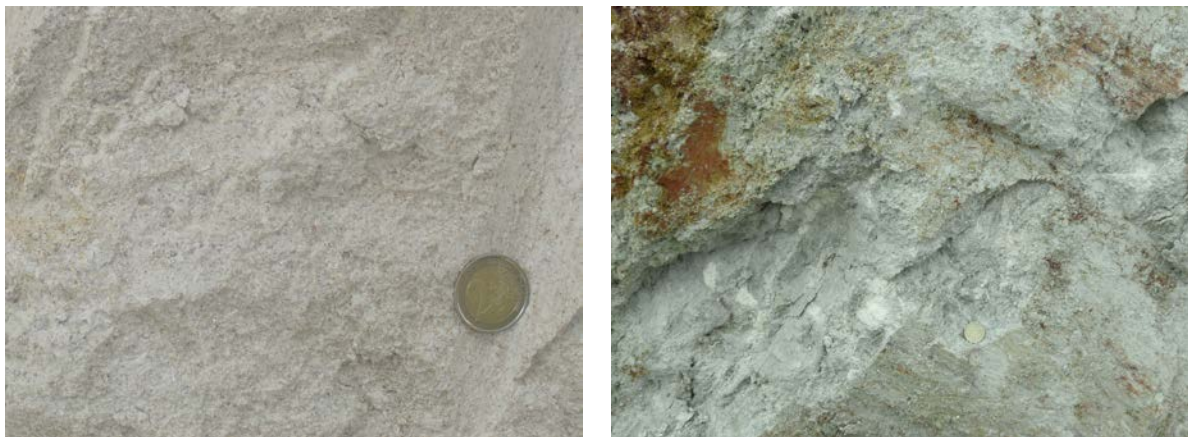
Fig.3.2. Aspecto de campo de las rocas de a) zonas de alteración homogénea (ZAHO) y b) Zonas de alteración heterogénea (ZAHE).
