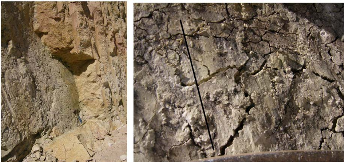
Figura.3.40 Evidencias de tectónica activa en el frente 2 de la cantera de Roderica N. A la izquierda un plano de falla subvertical del que se ha desprendido un fragmento de uno de los bloques. A la derecha una imagen de detalles del espejo de falla en la que se pueden observar las estrías provocadas por el movimiento sub-vertical de un bloque con respecto al otro.
