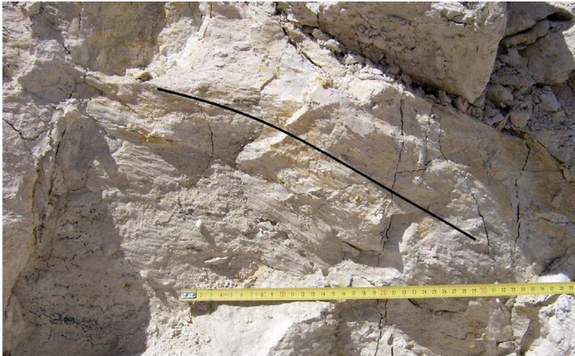
Figura.3.26 Detalle de un plano subvertical, marcado por la orientación de arcillas, con desplazamiento próximo a la horizontal, al SE del frente 1 de la cantera de Roderica.
