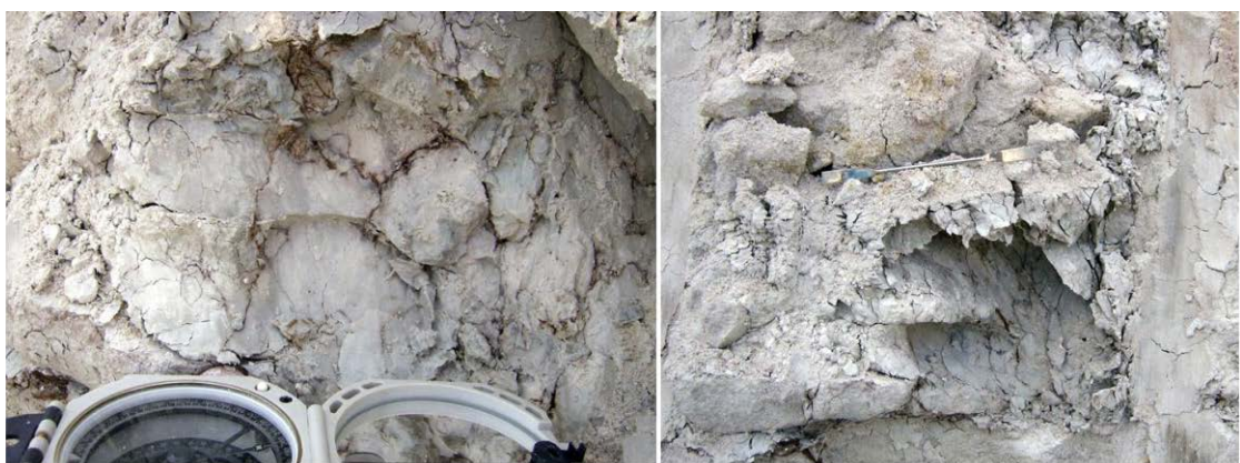
Figura.3.45 Masas de esmectitas muy plásticas incluidas en los sedimentos terciarios del frente 3 de Roderica N.
