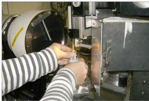
Fig.2.13 Detalle de la colocación de muestra en la ID18F, a la izquierda la cámara MAR165.
