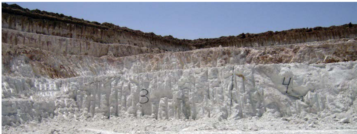
Fig.1.20 Marcas en un frente de cantera clasificando los materiales en función de la relación caolinita/esmectita.
