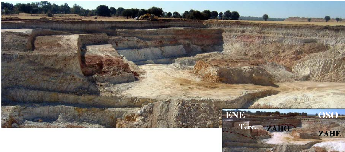
Figura.3.27 Imagen del frente S de Roderica (frente 2 en la Fig.3.27). El Terciario es bastante potente, ya que el granito alterado está únicamente en el banco inferior.
