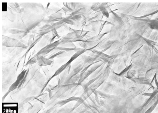
Figura.8.6 Aspecto general de la esmectitas, clasificadas como beidellitas, de la muestra Nav5.
