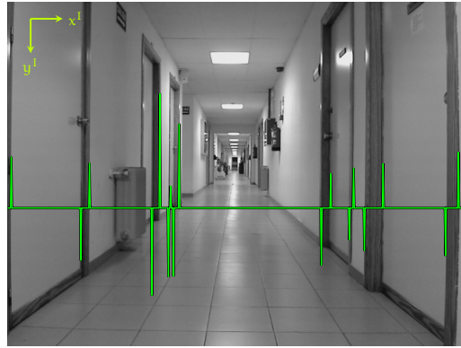
Figura 5.3.7: Superposición de los valores de la figura 5.3.6 sobre la imagen de ejemplo. Los picos coinciden con las líneas verticales en la imagen.
