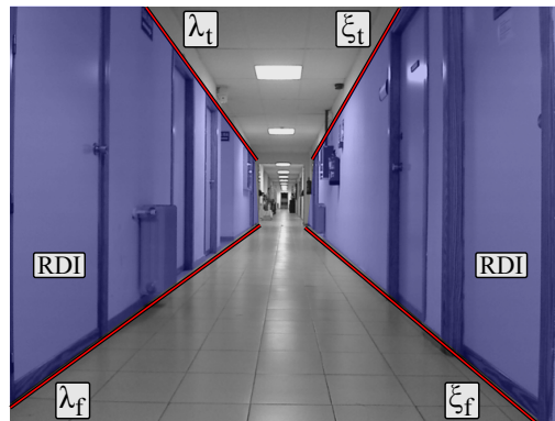
Figura 5.3.1: Regiones de interés en la imagen, junto con las cuatro líneas utilizadas para definir las.
