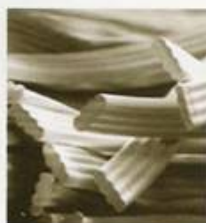
Figura 12. Fibra com quatro 36 (esquerda) e com seis 37 canais (direita) de Coolmax 36
