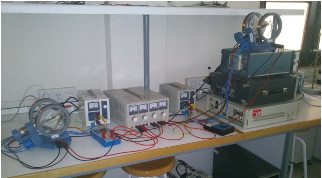
Figura 1: Fotografía de los dos puestos similares que existen en el laboratorio para la realización del cálculo de la relación e/m del electrón (Nota: el puesto de la izquierda es el que se ha comprado con esta dotación –Figura 2-; el tercer puesto tiene unos elementos ligeramente diferentes aunque el fundamento físico y de operación es análogo a estos dos)
