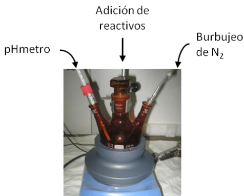
Figura 21 Fotografía del sistema de síntesis en el laboratorio.
