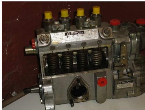
Fig. 2.7 Aspecto exterior de una bomba lineal
