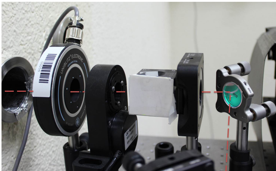
Figura 9: Dispositivo de selección del número de pulsos (obturador mecánico, a la izquierda), dispositivo de control de la energía de pulso (lámina \lambda/2 y polarizador lineal) y espejo.
