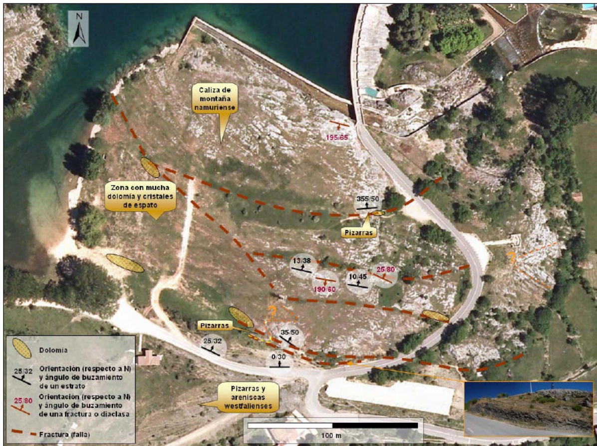
Figura 265. Observaciones en el estribo derecho de la presa y en el cerro
