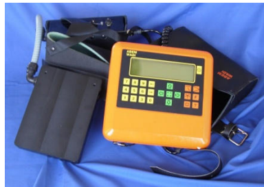
Imagen 12. Equipo VLF diseñado por la empresa Abem Wadi
