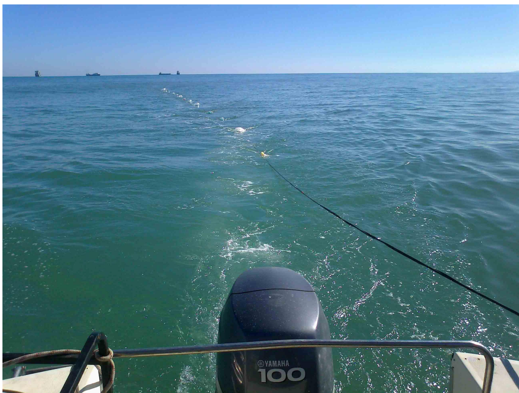
Imagen 65. Vista general de la zona de estudio con dispositivo adoptado para realización de Tomografía Eléctrica marina. Valencia. Enero de 2.012.
