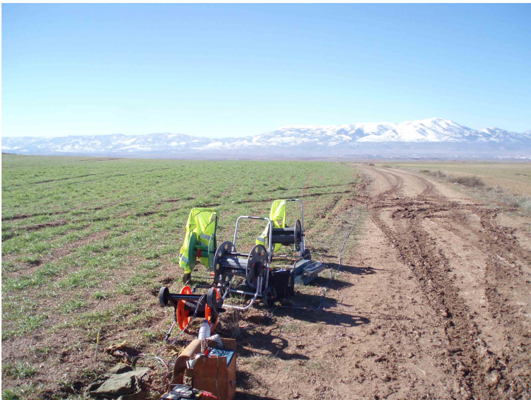
Imagen 61. Vista general de zona de estudio con dispositivo adoptado para realización de Tomografía Eléctrica profunda. Baza (Granada). Enero de 2.011.
