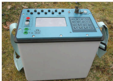
Imagen 6. Equipo Syscal-Pro diseñado por la empresa Iris Instrument
