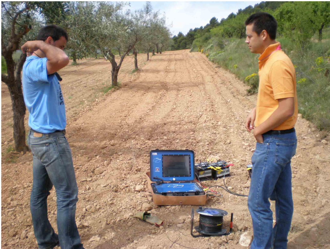
Imagen 64. Vista general de la zona de estudio con dispositivo adoptado para realización de SEDT. Higuieruelas (Valencia). Mayo de 2.009.
