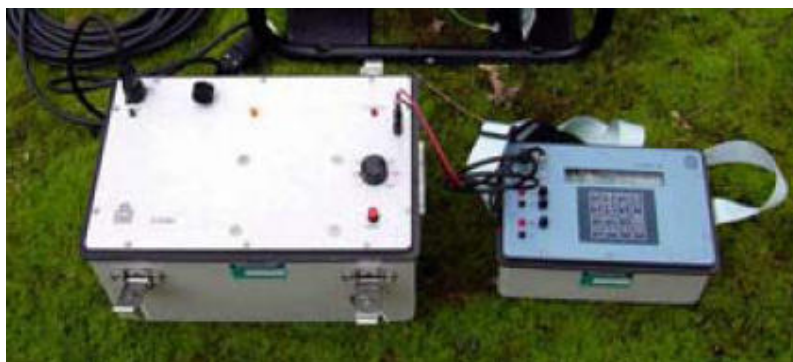
Imagen 7. 1200 W AC DC converter diseñado por la empresa Iris Instruments
