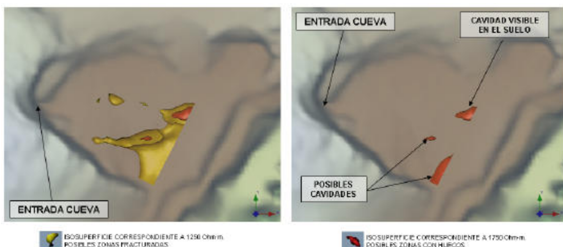
Figura 152. Imagen cenital de las isosuperficies generadas para delimitar la zona de posibles cavidades y de fracturación (Software Voxler).
