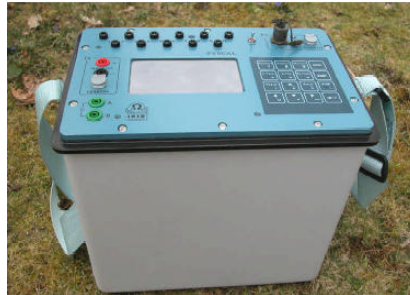
Imagen 5. Equipo Syscal-Pro desarrollado por la empresa Iris Instruments
