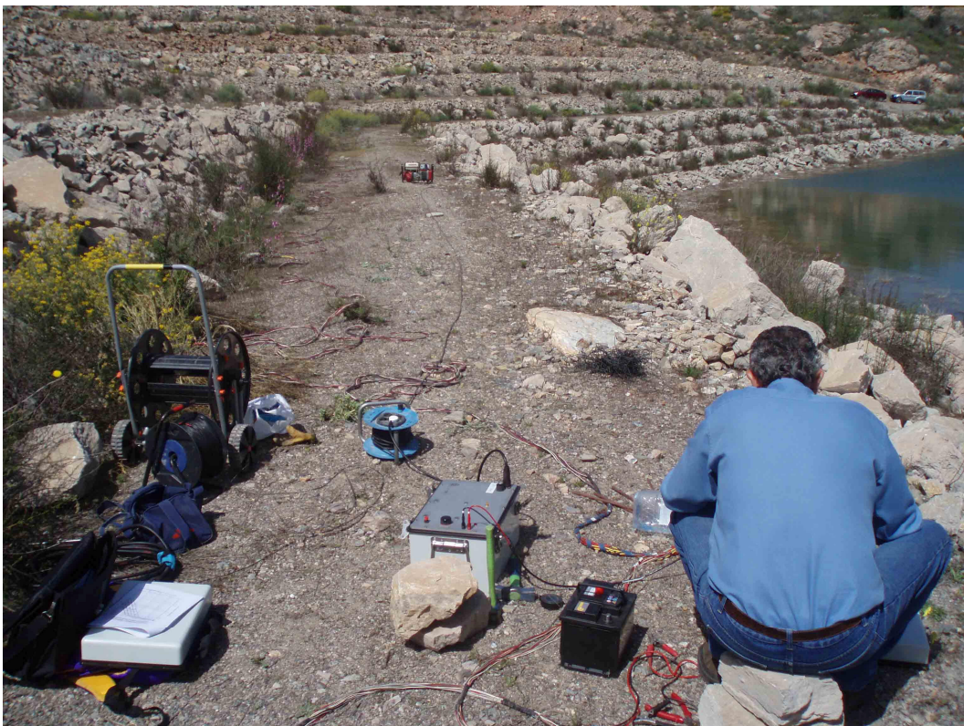
Imagen 55. Vista general de zona de estudio con dispositivo adoptado para realización de Polarización inducida. Embalse de Beninar (Granada). Octubre de 2.008.
