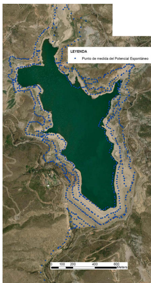
Figura 303. Distribución espacial de los puntos de investigación del Potencial Espontáneo realizados en las márgenes del embalse de Benívar (Software ArcGIS).
