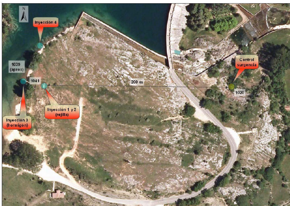
Figura 269. Ubicación de inyecciones y cotas aproximadas
