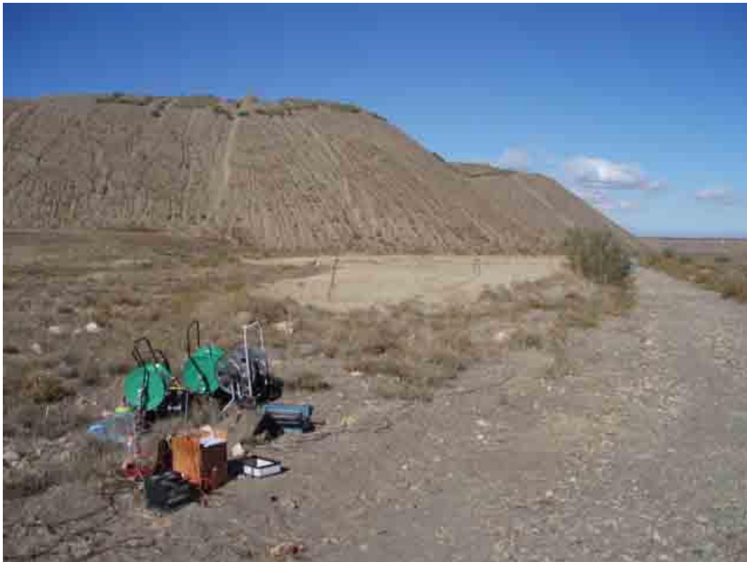
Imagen 52. Vista general de zona de estudio con dispositivo adoptado para realización de Tomografía Eléctrica profunda. Guadix (Granada). Julio de 2.010.
