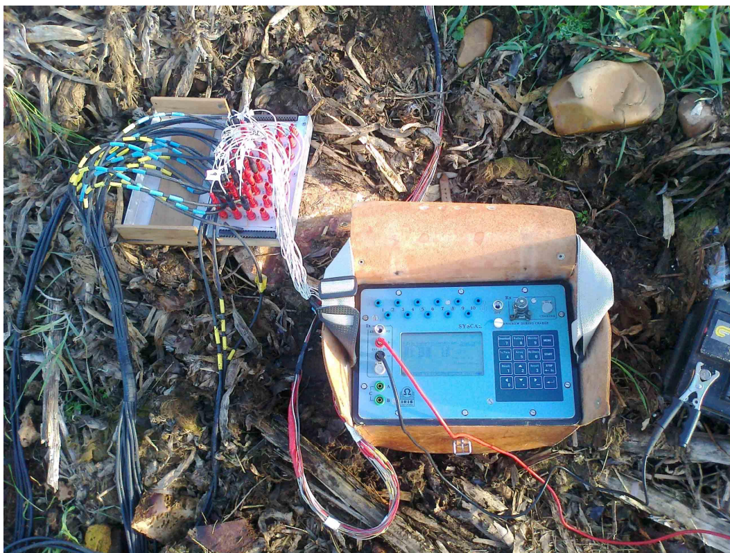
Imagen 50. Detalle del Equipo Syscal-Pro y disposición de las conexiones para la realización de tomografía eléctrica acuática. Río Guadiana (Mérida). Enero de 2012.
