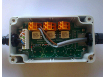
Imagen 17. Dispositivo de protección externa del equipo TerraTem diseñado por Mones Geoscope.
