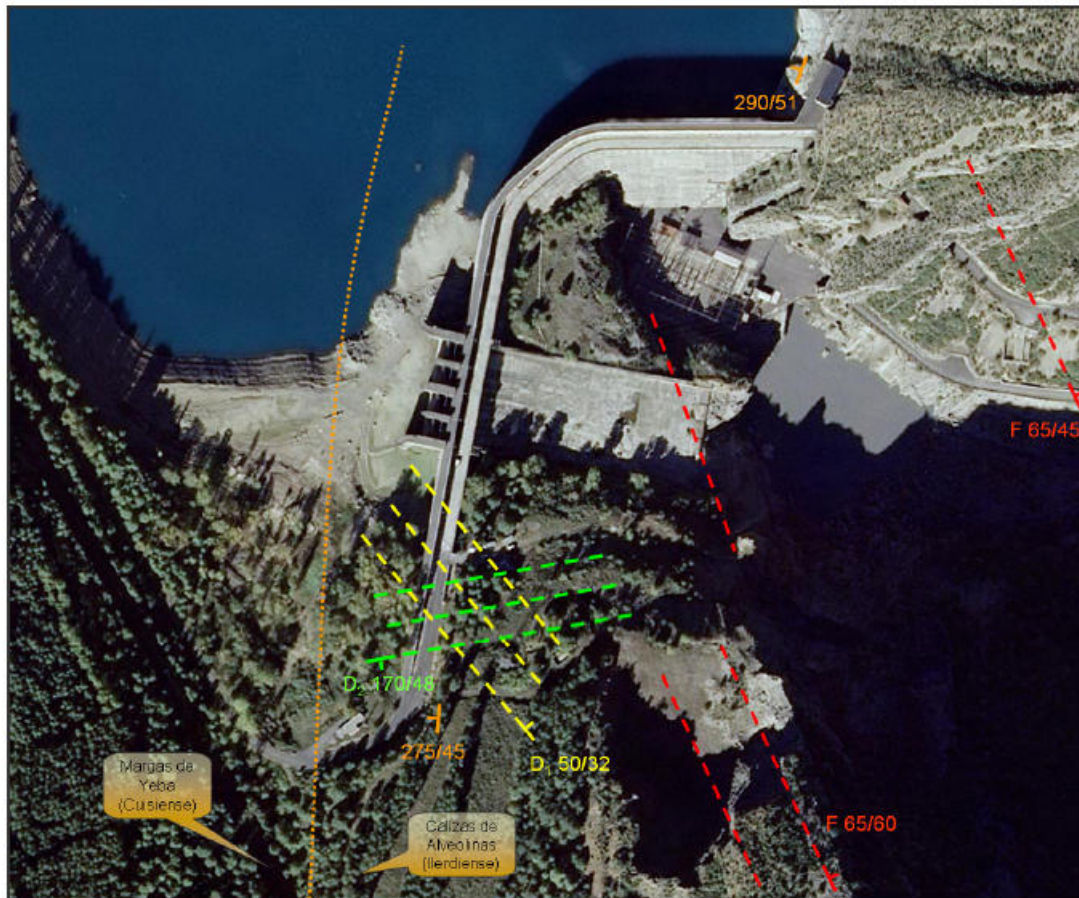
Figura 212. Orientaciones de los principales sistemas de diaclasas (D) y fracturas (F), así como de capas (en naranja)
