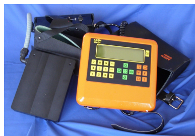
Imagen 13. Equipo VLF diseñado por Abem Wadi
