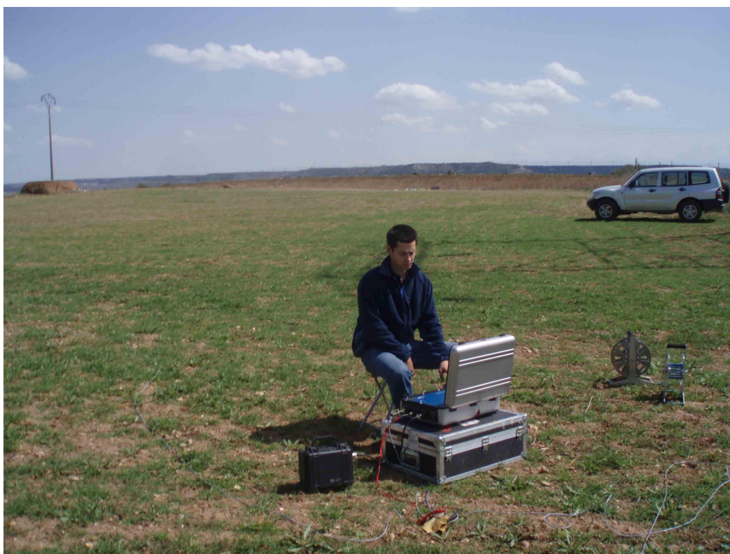
Imagen 51. Vista general de zona de estudio con dispositivo adoptado para realización de SEDT. Cigales (Valladolid). Marzo de 2010.
