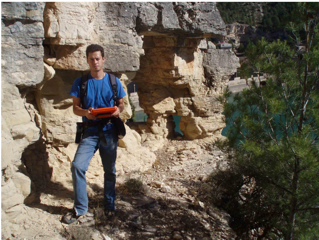
Imagen 59. Realización de la tomo de datos con equipo Abem Wadi (VLF). Embalse de Santolea (Teruel). Julio de 2010.
