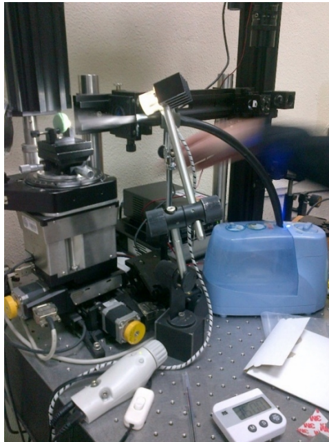
Figura 31: Sistema de humidificación empleado en el procesado de esmalte para los estudios de adhesión.
