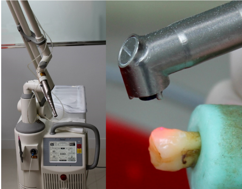
Figura 7: (a) Láser de Er:YAG (Fidelis plus III) (b) pieza de mano R02 en modo no contacto.
