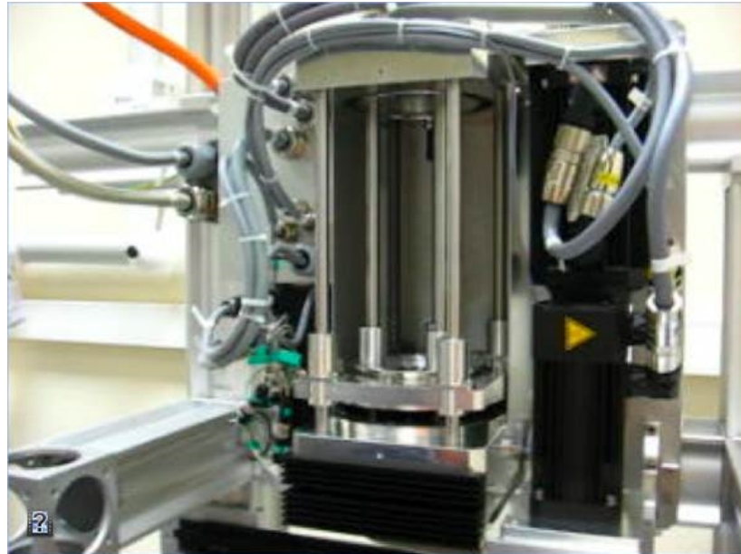
Figura 22: Sistema de trepanado óptico del Grupo de Microprocesado de Materiales con Láser de la Universidad de Salamanca.
