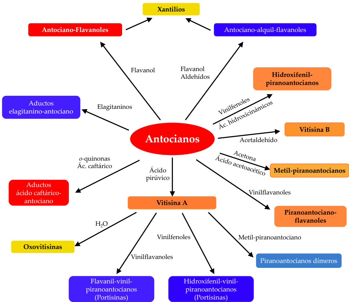
Figura I.20: Esquema de la formación de los derivados de antocianos en los vinos.
