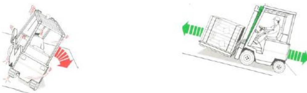
Figura 3. Correcta circulación con la carretilla elevadora en una pendiente.
