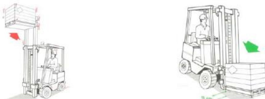
Figura 2. Circulación correcta con la carretilla cargada.
