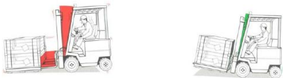
Figura 1. Colocación correcta de la carga en una carretilla elevadora.
