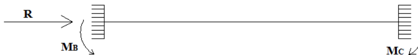
Figura A-3. 68. Hipótesis de cargas que actúan sobre el dintel para el predimensionamiento.
