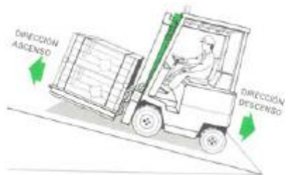
Figura 4. Circulación en pendientes con carga.
