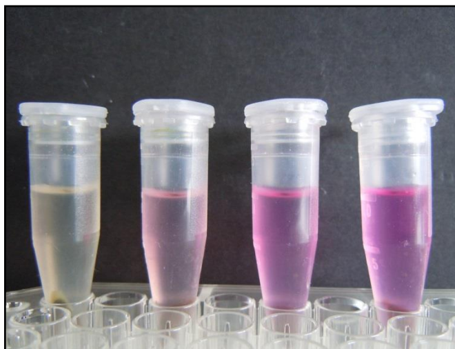
Figura 3.13. Compuesto coloreado generado por reacción del diazo-compuesto, resultante de la reacción de la sulfanilamida con el nitrito, con una amina aromática del NNEDA.
