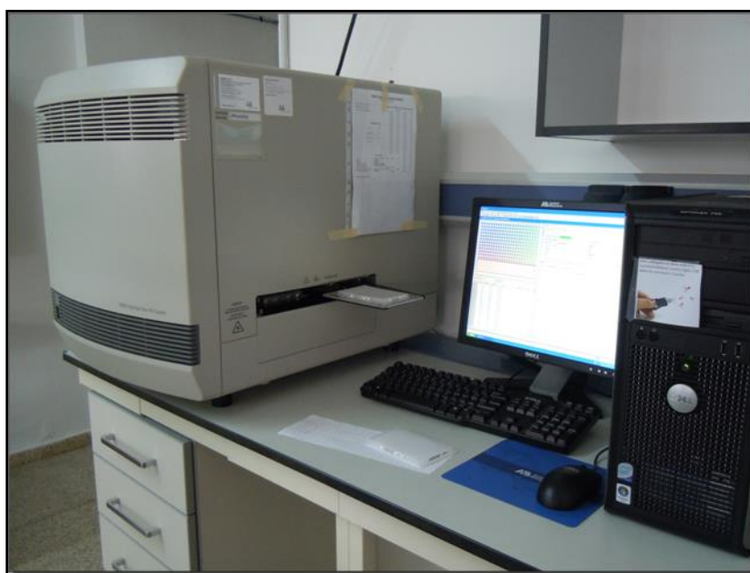
Figura 3.19. Sistema de PCR cuantitativa en tiempo real qRT-PCR: equipo ABI PRISM ® 7900 HT Fast Real-Time PCR System (Applied Biosystems)
