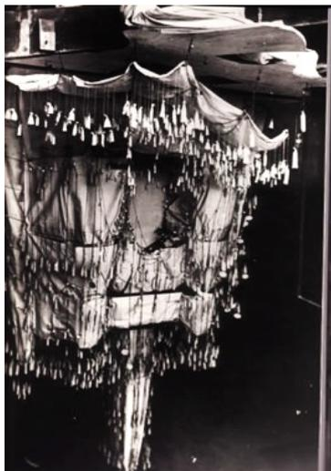
Fig.68. Modelo funicular de la Iglesia de la Colonia Güell. Fuente: GIRALT-MIRACLE, D. *La búsqueda de la forma...*, p. 99.
