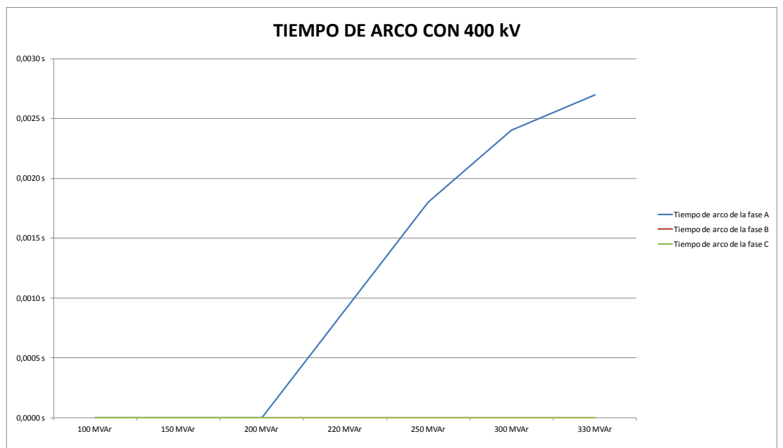
Figura 3.4.3.7. Gráfica de los tiempos de arcos para 400 kV de la tabla 3.4.3.2.
