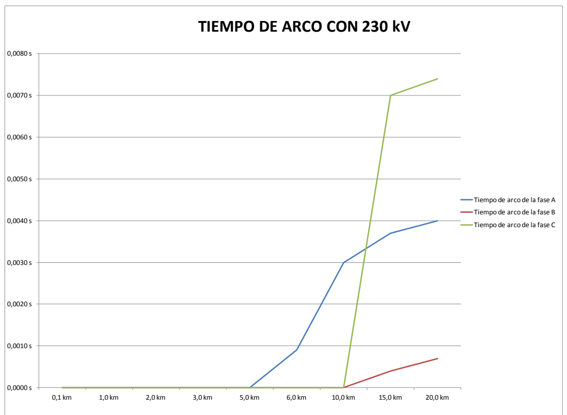
Figura 3.5.9.3. Gráfico de tiempos de arco de cables con variación de la tensión y la longitud del cable.
