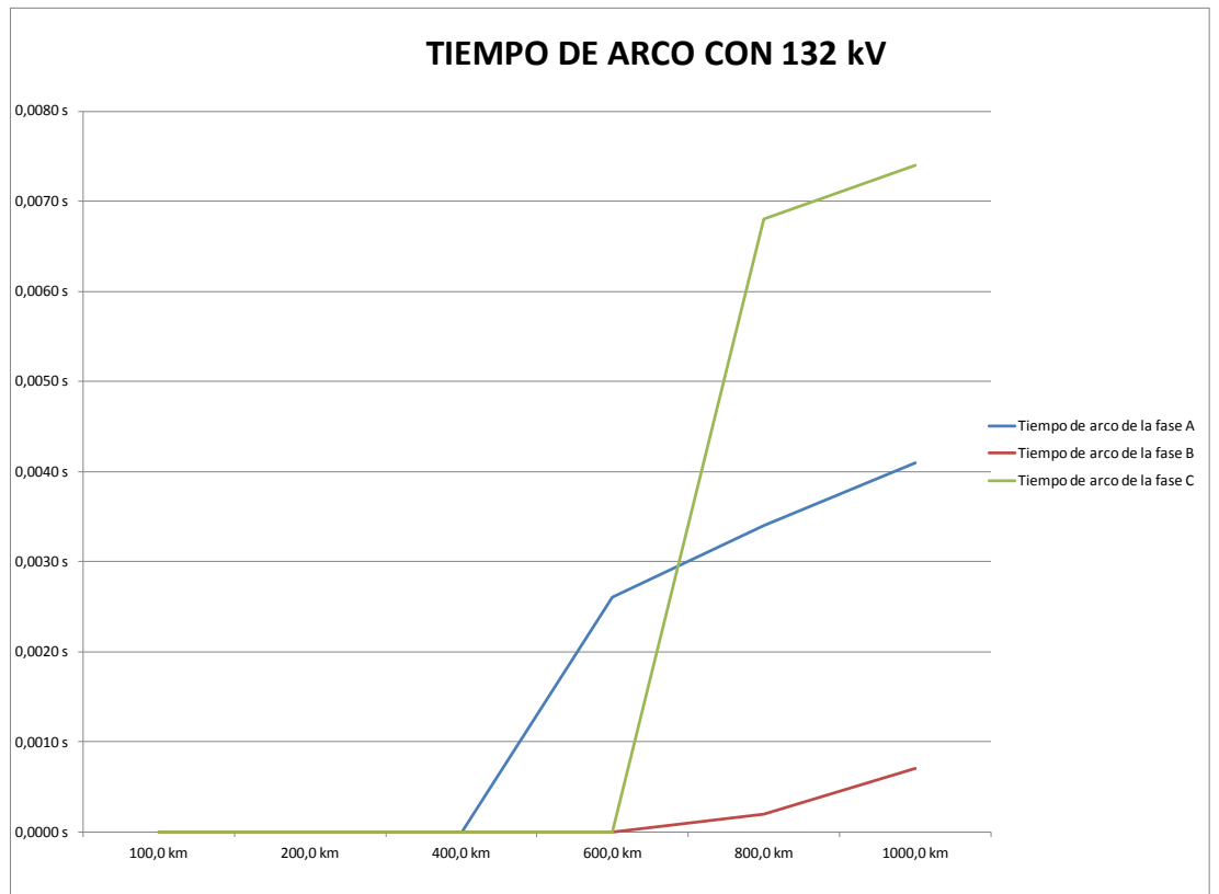
Figura 3.5.11.4. Gráfico de tiempos de arco de líneas con variación de la tensión y la longitud.
