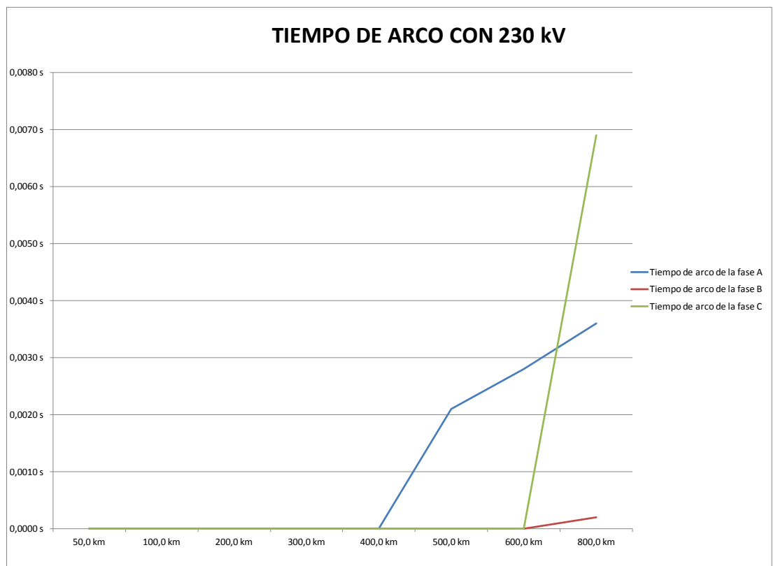
Figura 3.5.11.3. Gráfico de tiempos de arco de líneas con variación de la tensión y la longitud.
