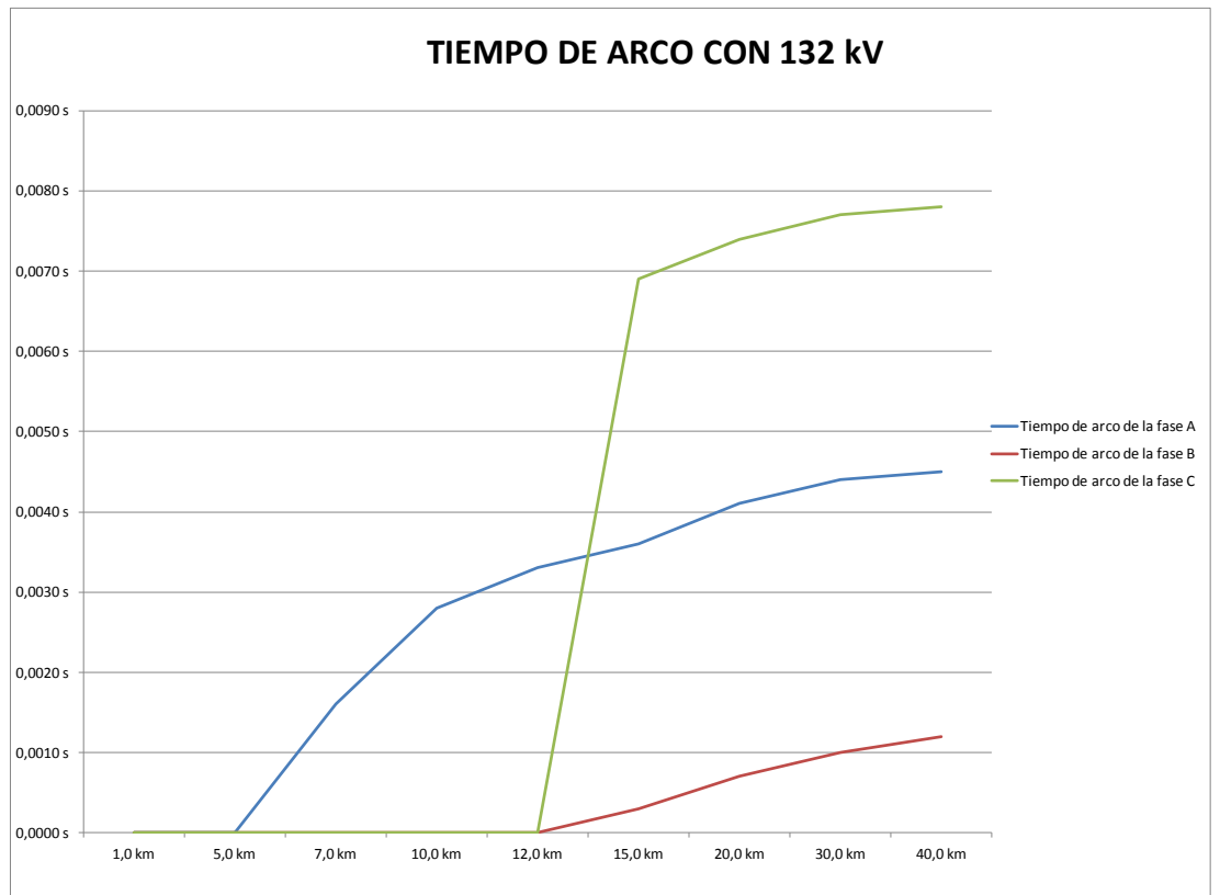
Figura 3.5.9.4. Gráfico de tiempos de arco de cables con variación de la tensión y la longitud del cable.
