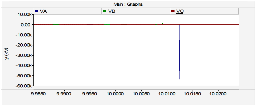
Figura 3.3.3.2.1. Tensiones en apertura reactancia 100 MVA r .
