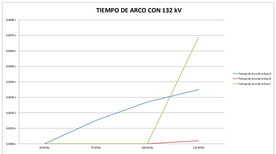
Figura 3.4.3.9. Gráfica de los tiempos de arcos para 132 kV de la tabla 3.4.3.2.
