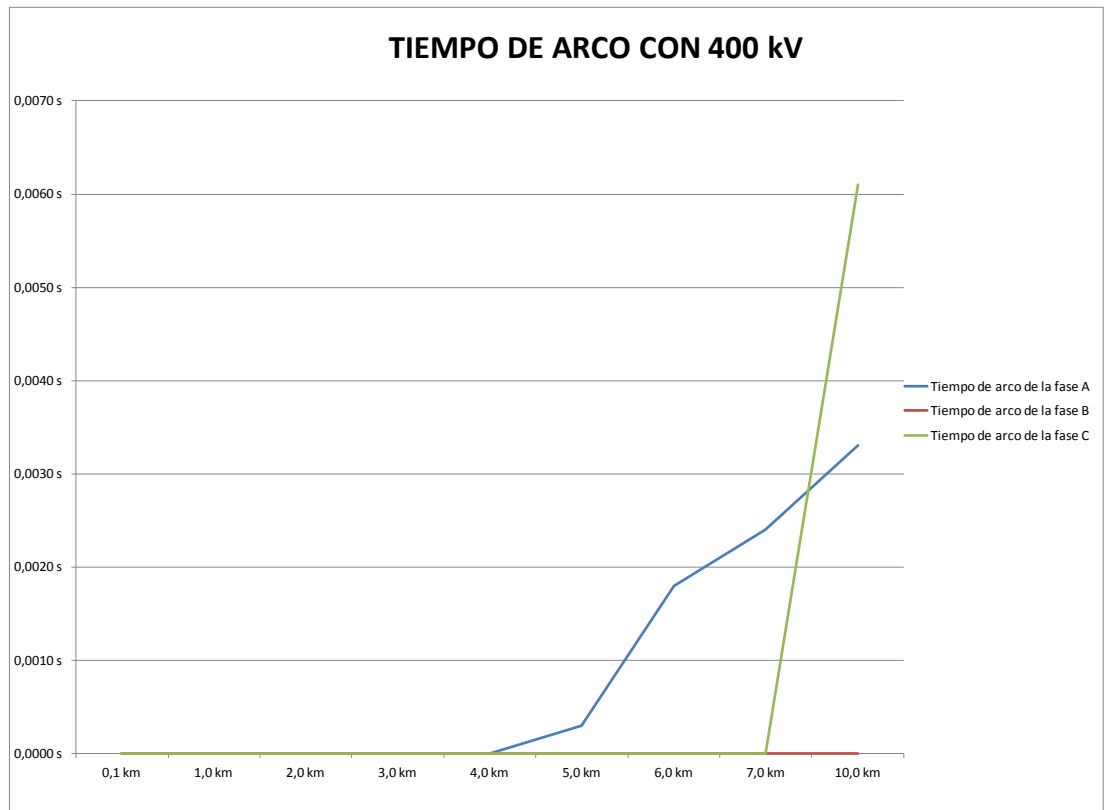
Figura 3.5.9.2. Gráfico de tiempo de arco de cables con variación de la tensión y la longitud del cable.
