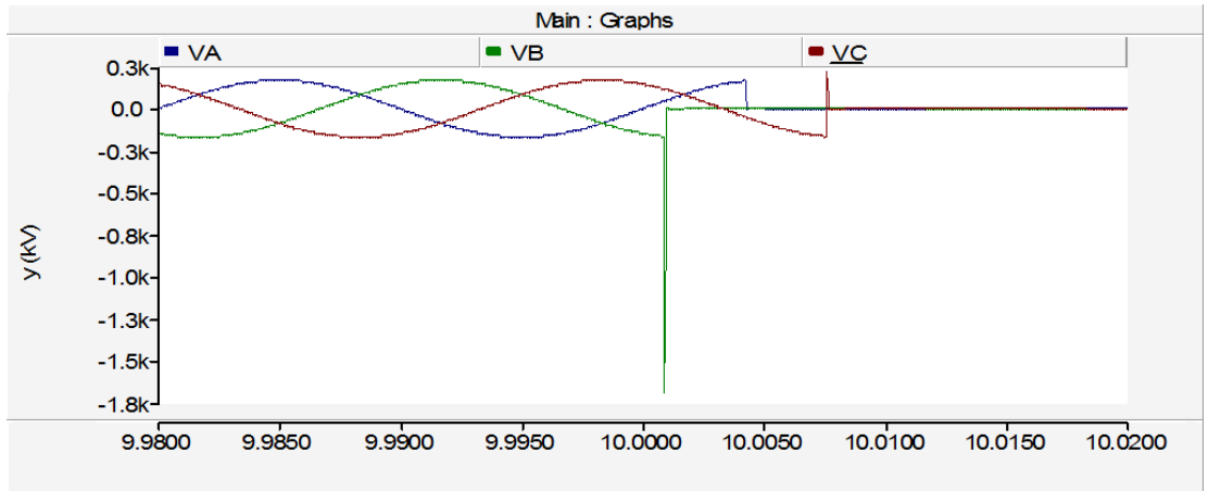
Figura 3.3.3.7.1. Tensiones en apertura reactancia 330 MVA r .
