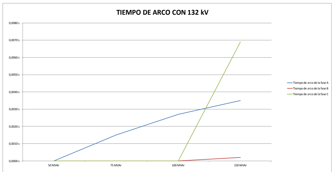
Figura 3.3.3.9. Gráfica de los tiempos de arcos para 132 kV de la tabla 3.3.3.2.
