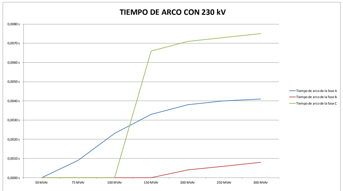
Figura 3.4.3.8. Gráfica de los tiempos de arcos para 230 kV de la tabla 3.4.3.2.
