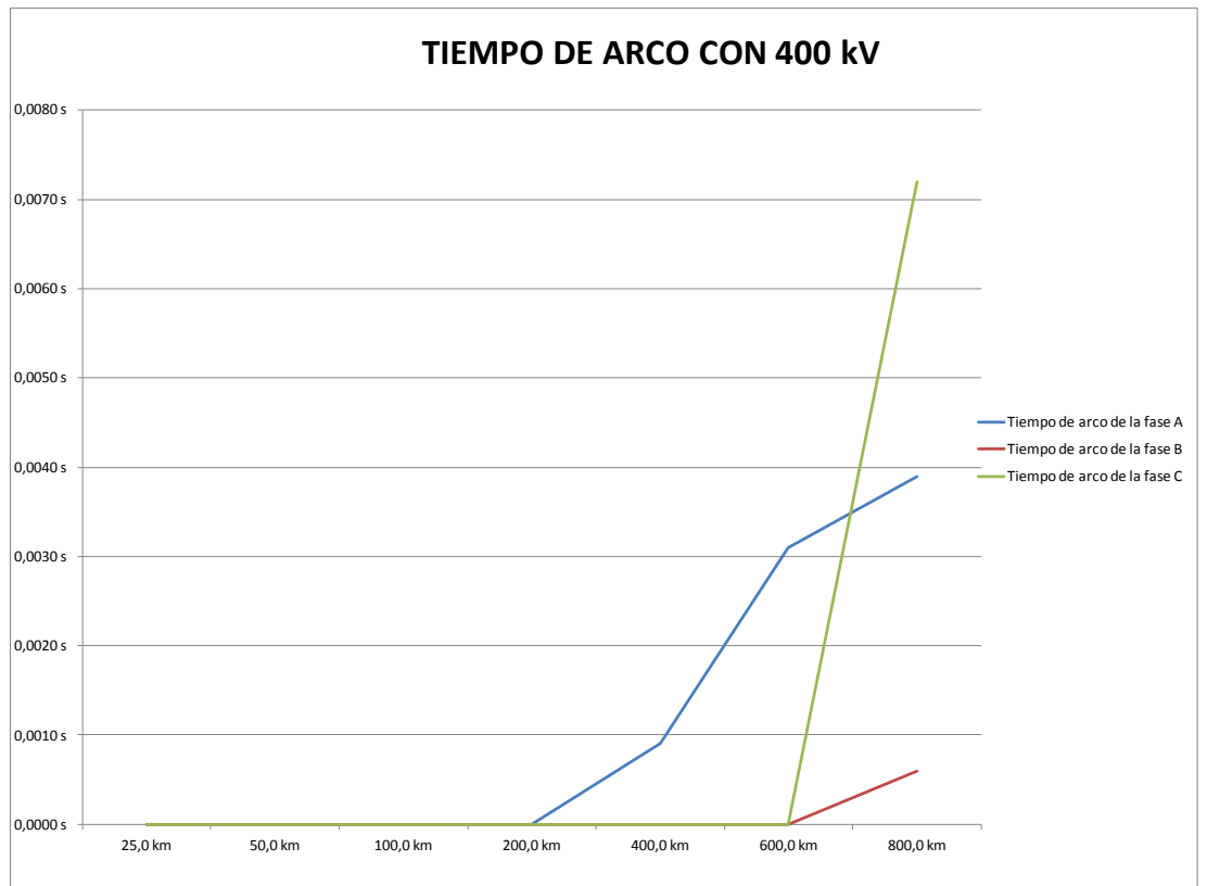
Figura 3.5.11.2. Gráfico de tiempo de arco de líneas con variación de la tensión y la longitud.
