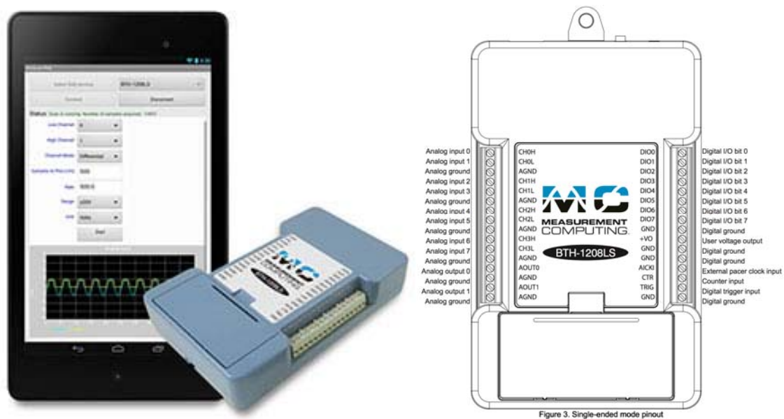
Figura 1. El sistema DAQ con una conexión con un Móvil a través de Bluetooth
