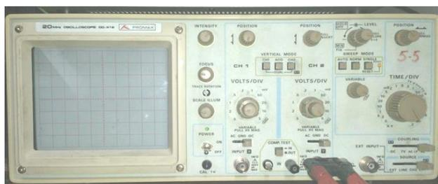
Figura 3. 18. Osciloscopio.
