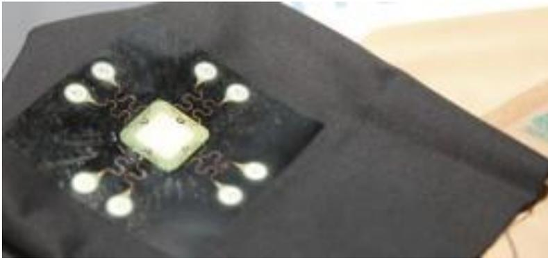
Figura 1. 11. Aplicación de un circuito conductor textil [47].
