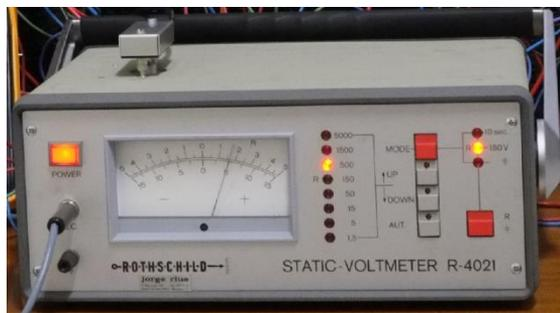
Figura 3. 16. Voltímetro estático R-4021(Rothschild).
