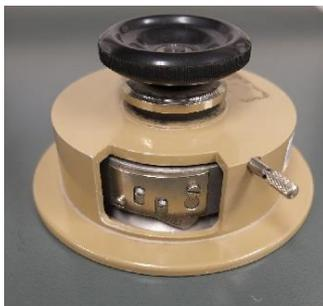
Figura 3. 14. Troquel o corta-probetas textil.
