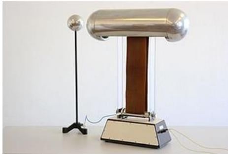
Figura 1. 8. Generador de electricidad electroestática.
