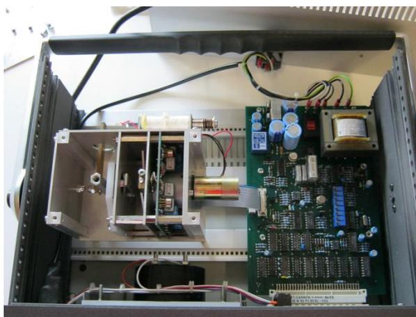
Figura 3. 39. Interior del voltímetro estático R-4021 Rothchild.
