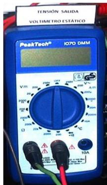
Figura 3. 17. Voltímetro de control de la tensión en la muestra.
