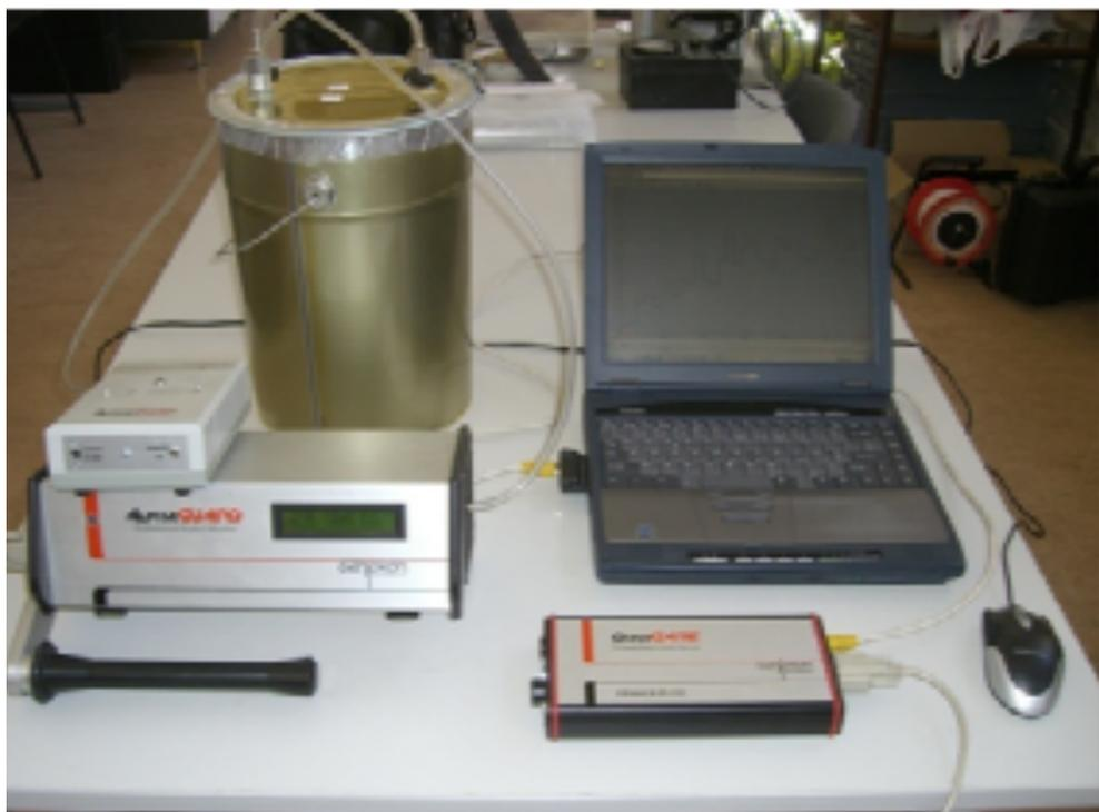
*Figura 20. Medición de cada contenedor con el equipo Alphaguard 2000 Pro.*
