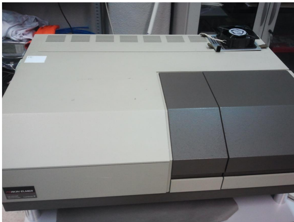
Figura. 3.10. Imagen del espectrofotómetro PERKIN ELMER Lambda 9.
