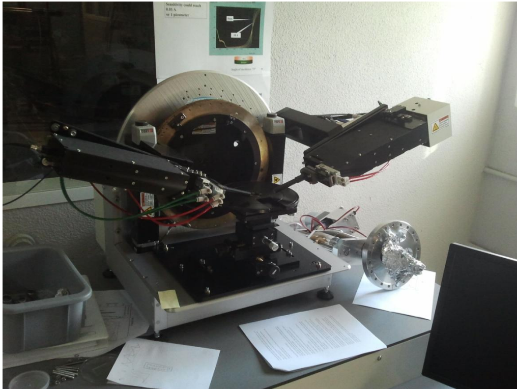
Figura. 3.9. Imagen del elipsómetro SOPRA GES 55..
