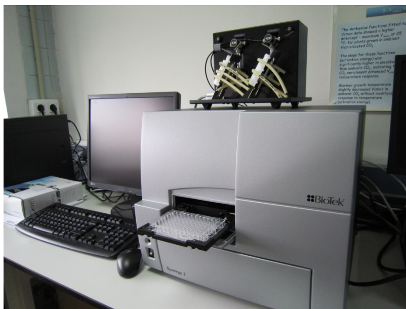
Figura 2.6. Espectrofotómetro-fluorímetro-luminómetro para placas Synergy 2.
