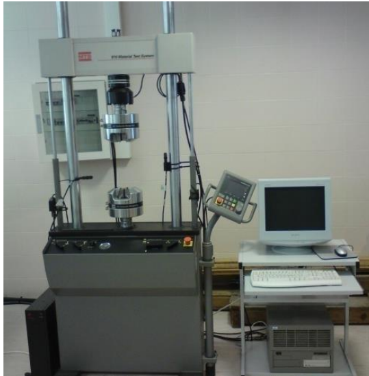
Fig. 2.3. Máquina universal de servo-hidráulica de ensayos mecánicos utilizada en los ensayos de prefisuración por fatiga de los aceros estudiados.
