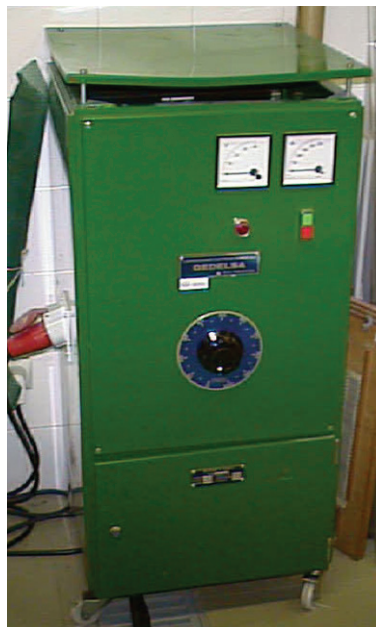
Figura 4.20. Fuente de alimentación de 7 kW.
