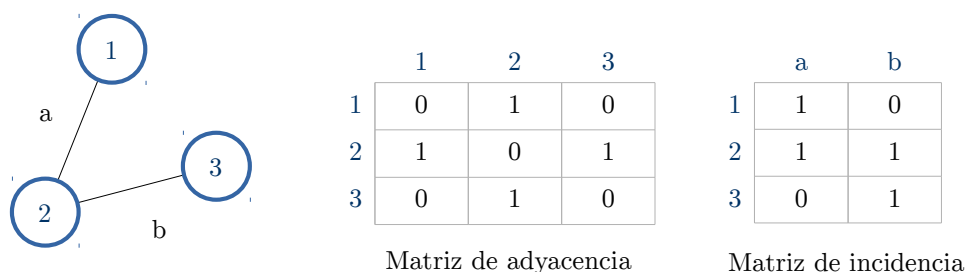
Figura 6. Matrices de adyacencia e incidencia. Ambas matrices representan la red dibujada a la izquierda.
