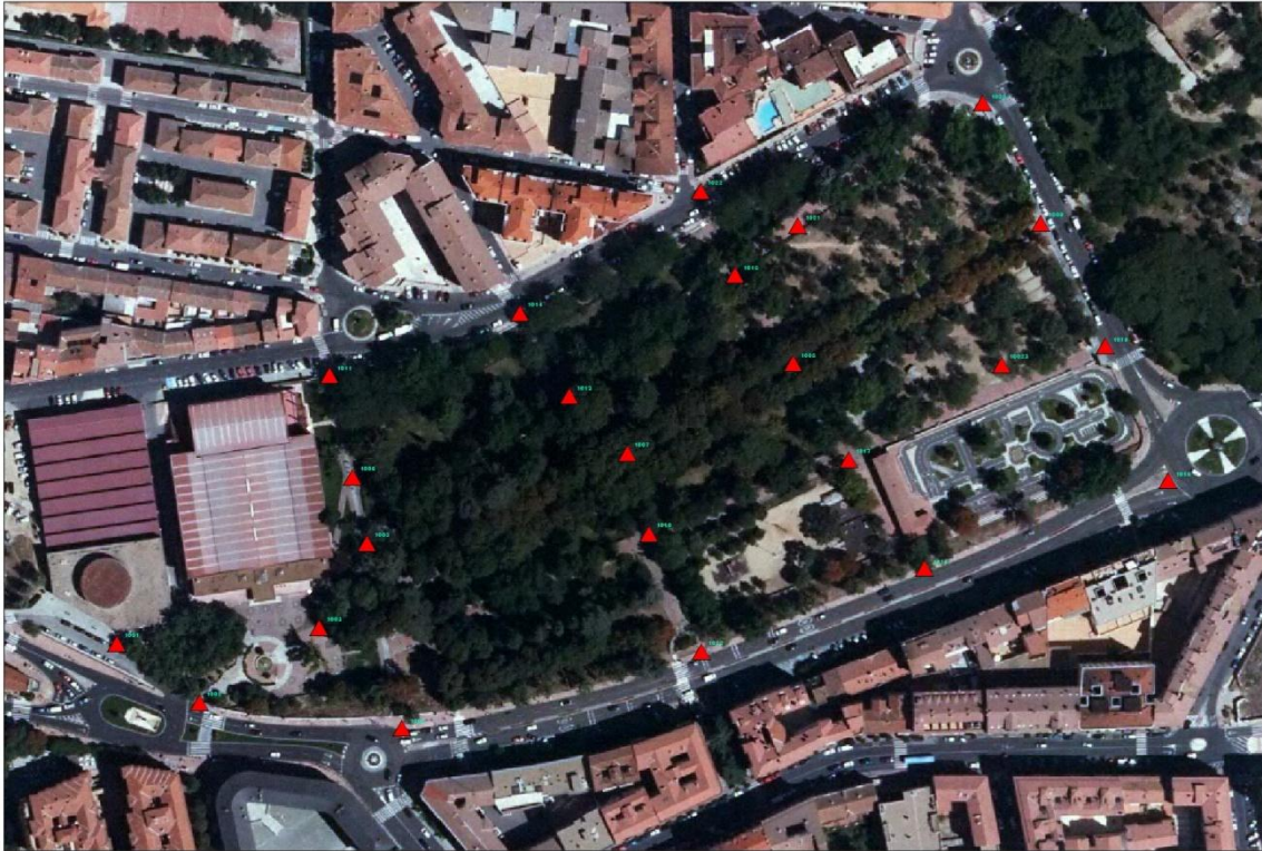
Figura 2.1 Distribución de los vértices en la zona del trabajo, fuente orto-foto de PNOA (captura de pantalla de ArcMap).
