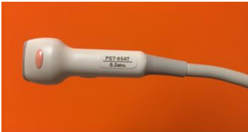
Fig. 25. Transductor sectorial Phase Array de 6,5 MHz de pequeño tamaño para adaptarse a las fontanelas.
