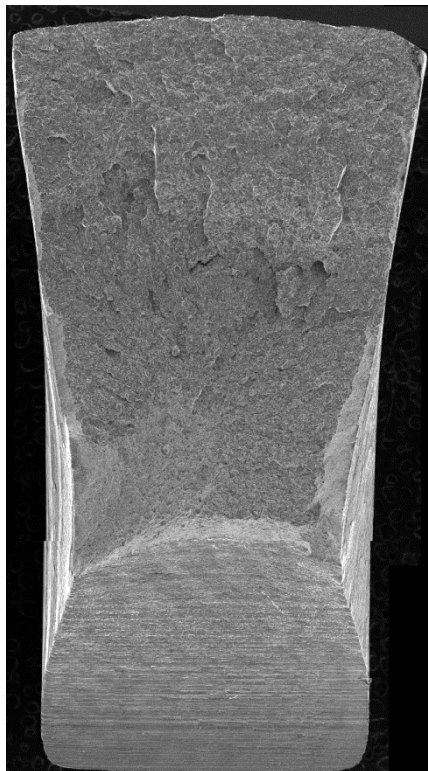
Fig. 3.102. Superficie de fractura de la probeta B0-C-2.
