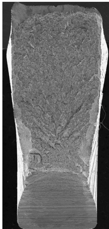
Fig. 3.110. Superficie de fractura de la probeta B4-C-3.
