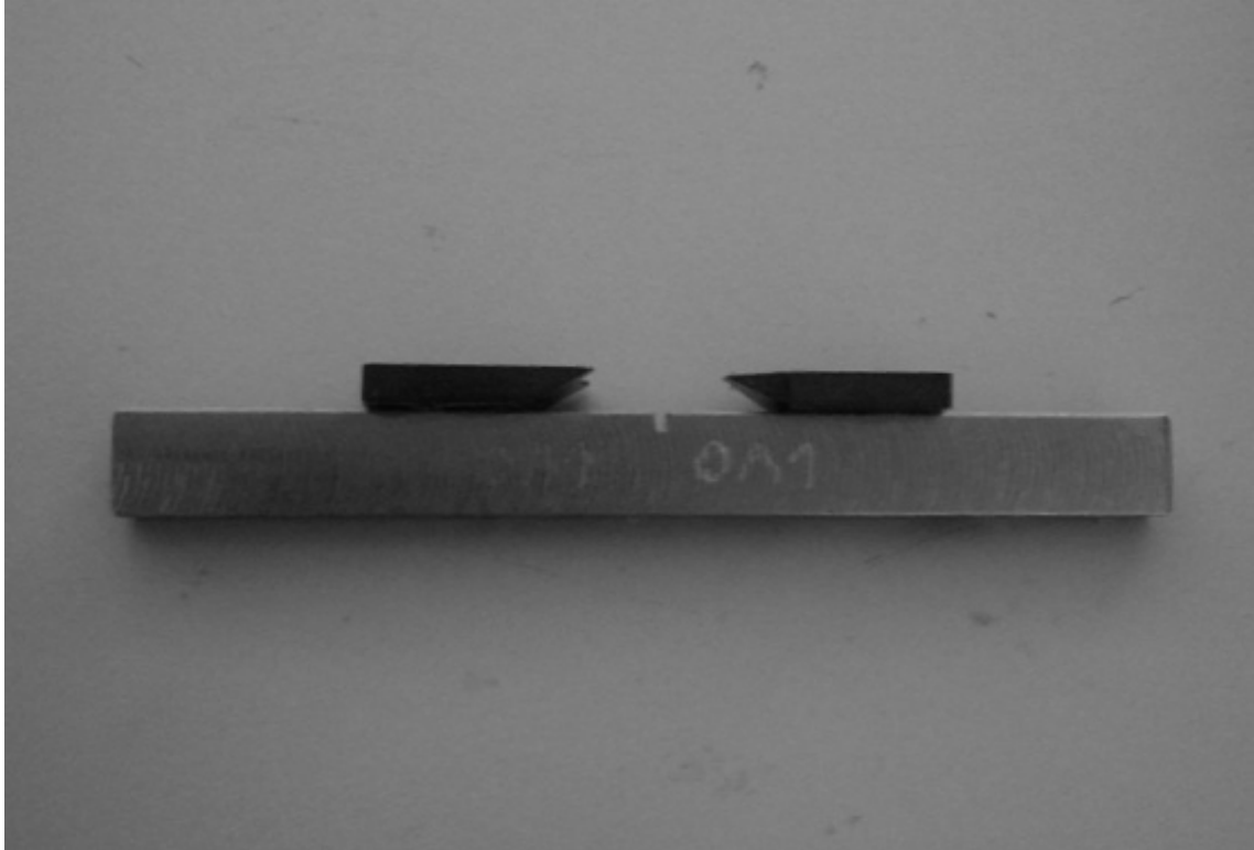
Fig. 2.22. Detalle de la colocación de las cuchillas que permiten el soporte del extensómetro.
