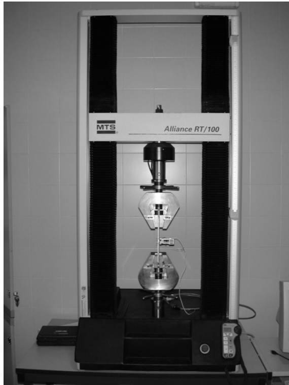
Fig. 2.4. Máquina utilizada en el ensayo de tracción.
