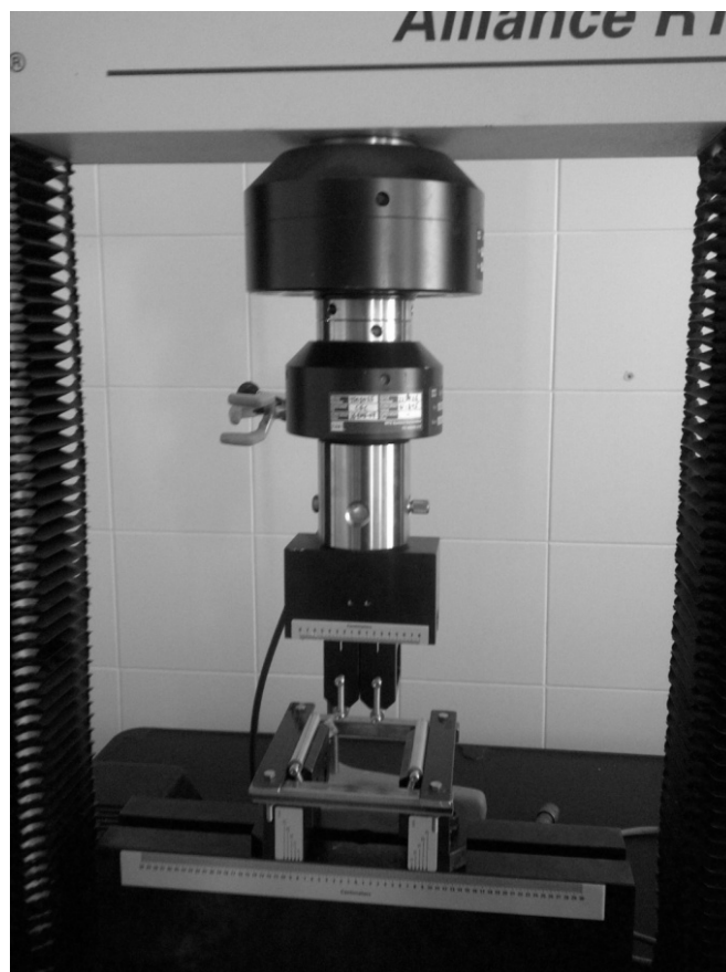
Fig. 2.20. Máquina MTS-RT/100 con el dispositivo de flexión por cuatro puntos.
