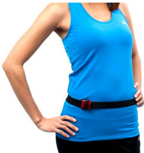
Figura 3. Dispositivo de medida de la actividad física Actigraph GT3X.
